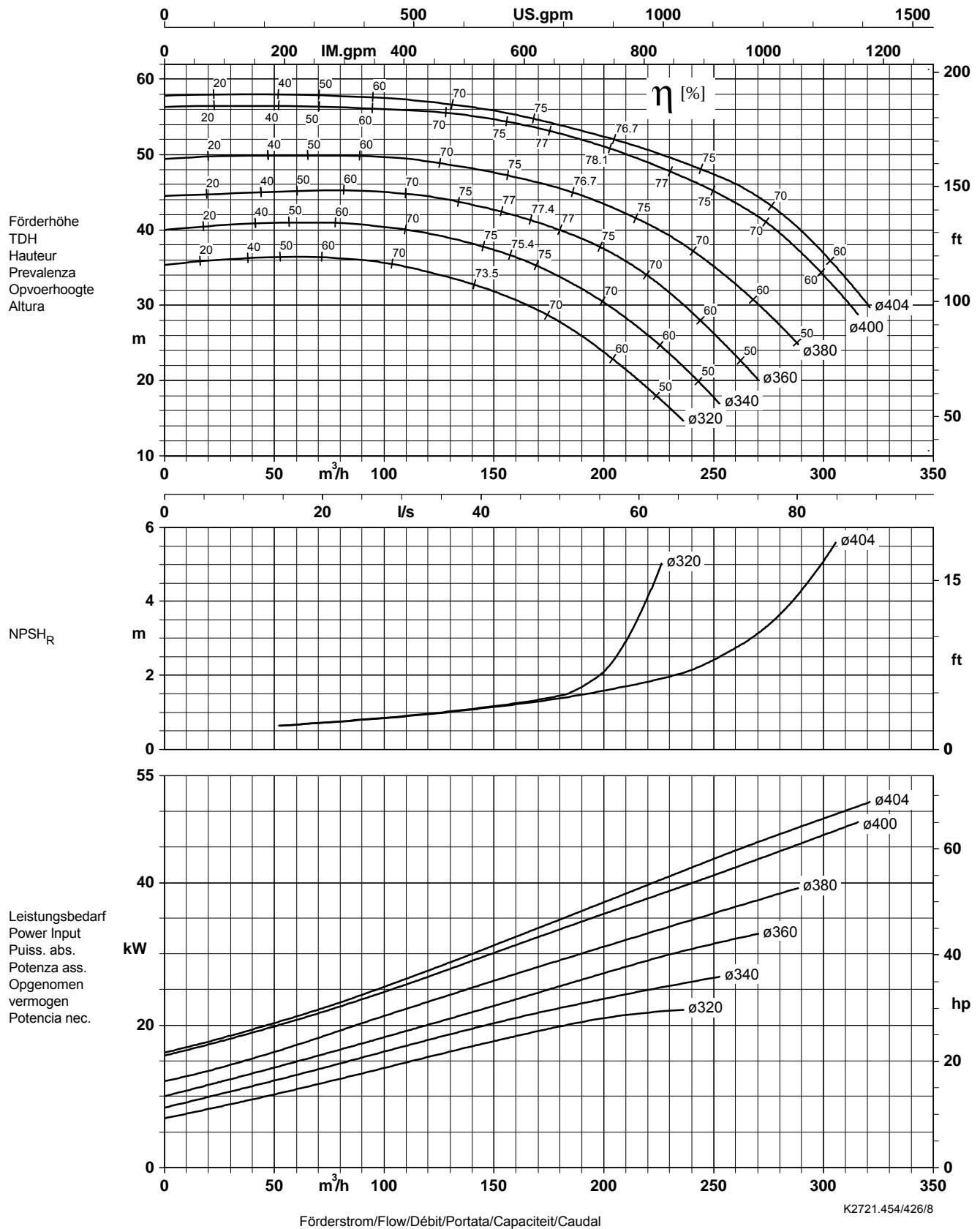
Laufradaustrittsbreite/Impeller outlet width/Largeur à la sortie de la roue 20,0 mm
