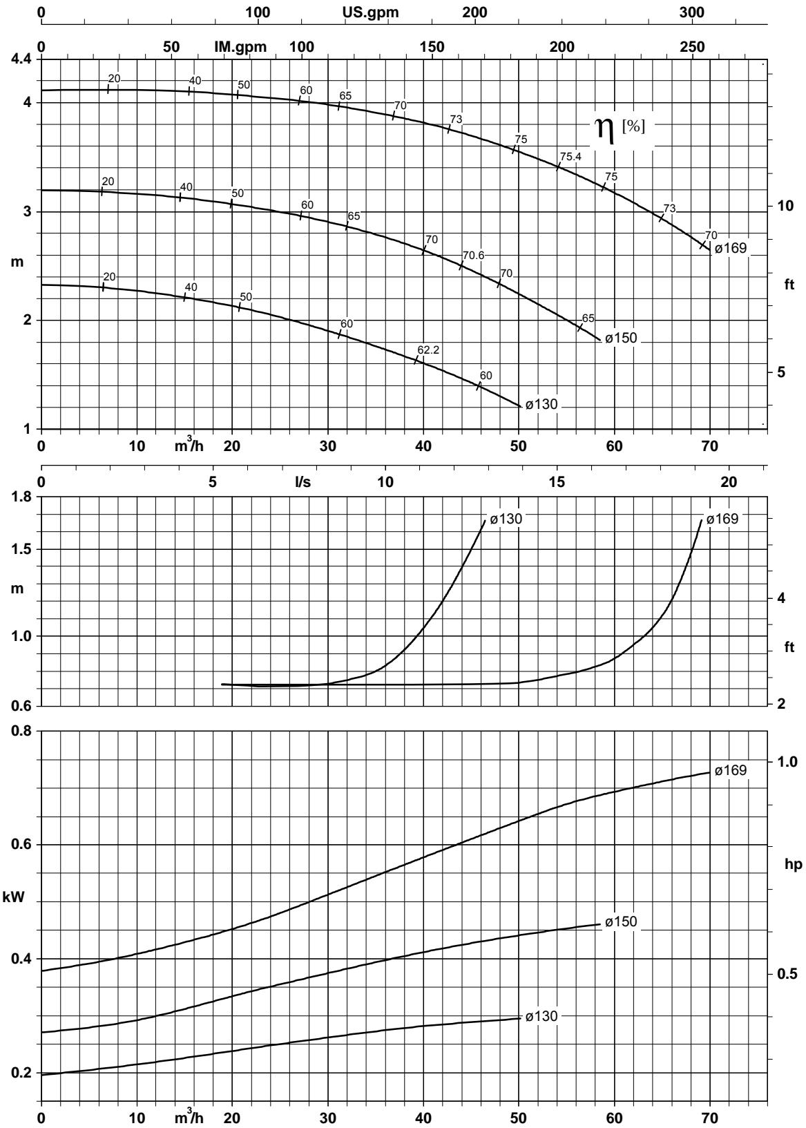
Laufraudaustrittsbreite/Impeller outlet width/Largeur à la sortie de la roue 27,0 mm
