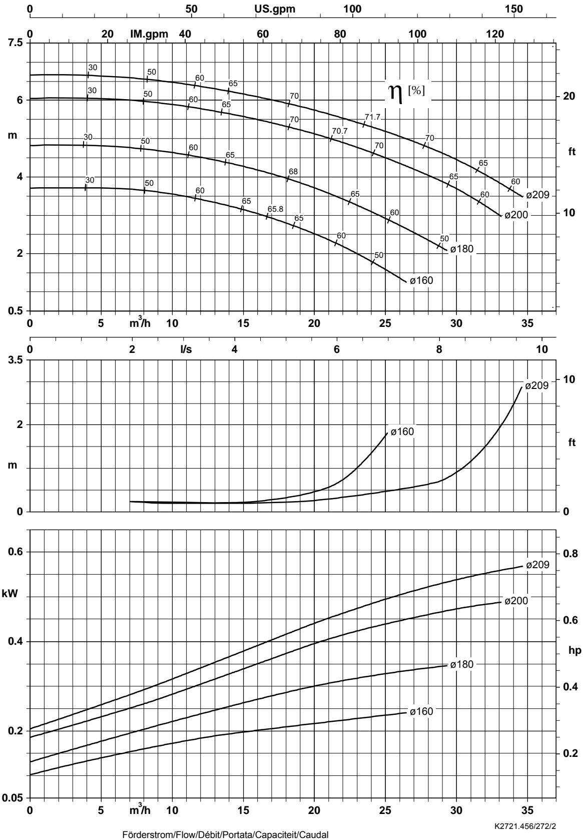
Laufradaustrittsbreite/Impeller outlet width/Largeur à la sortie de la roue 12,0 mm
