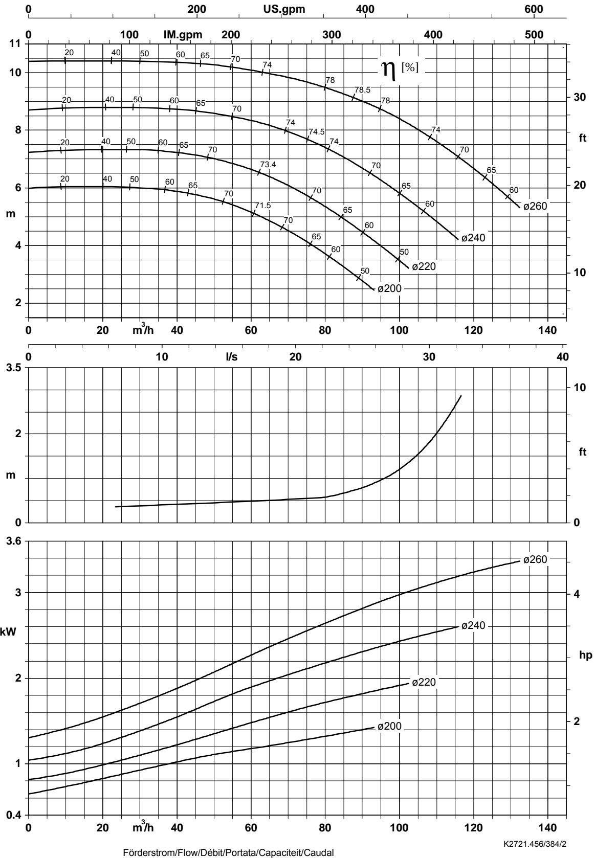
Laufradaustrittsbreite/Impeller outlet width/Largeur à la sortie de la roue 23,0 mm
