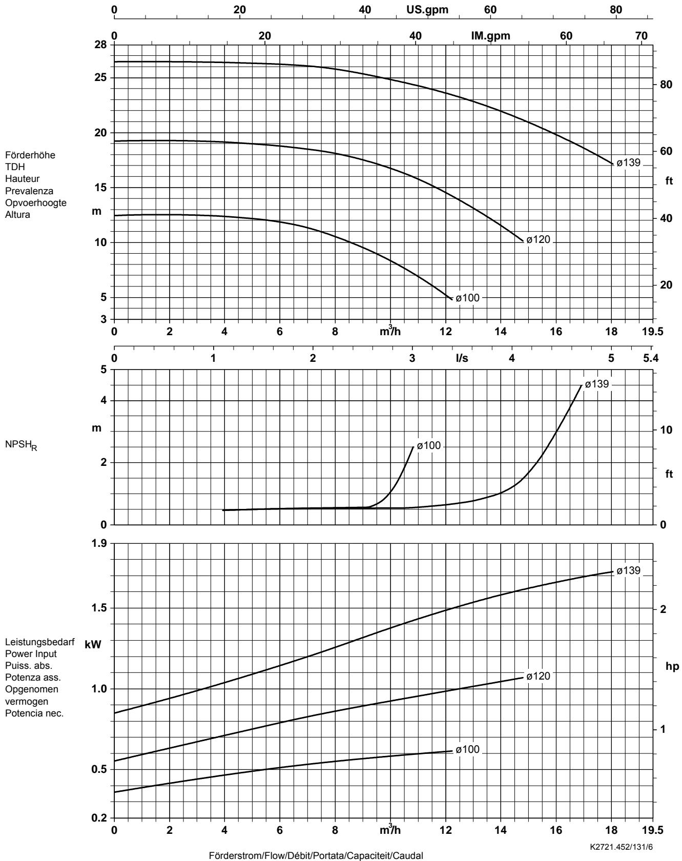
Laufraustrittsbreite/Impeller outlet width/Largeur à la sortie de la roue 8,0 mm
