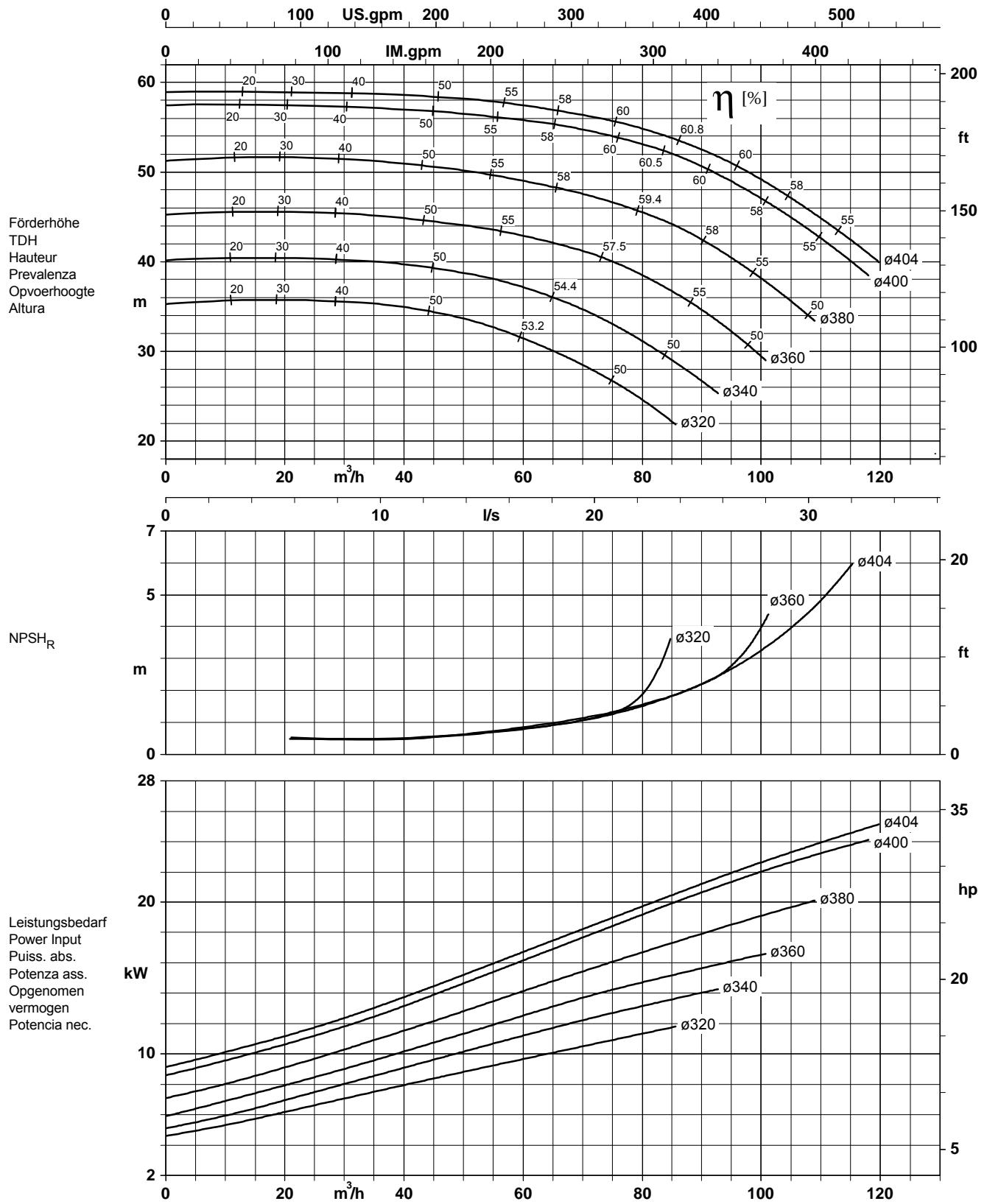
Laufradaustrittsbreite/Impeller outlet width/Largeur à la sortie de la roue 11,0 mm
