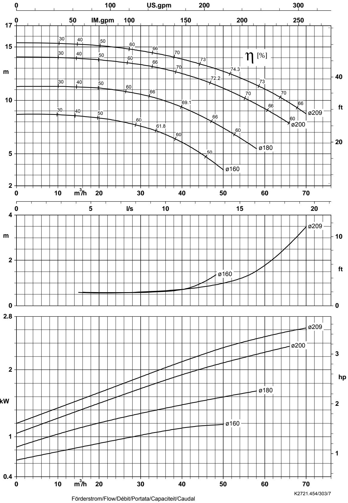
Laufrauaduistrtsbreite/Impeller outlet width/Largeur à la sortie de la roue 16.0 mm
