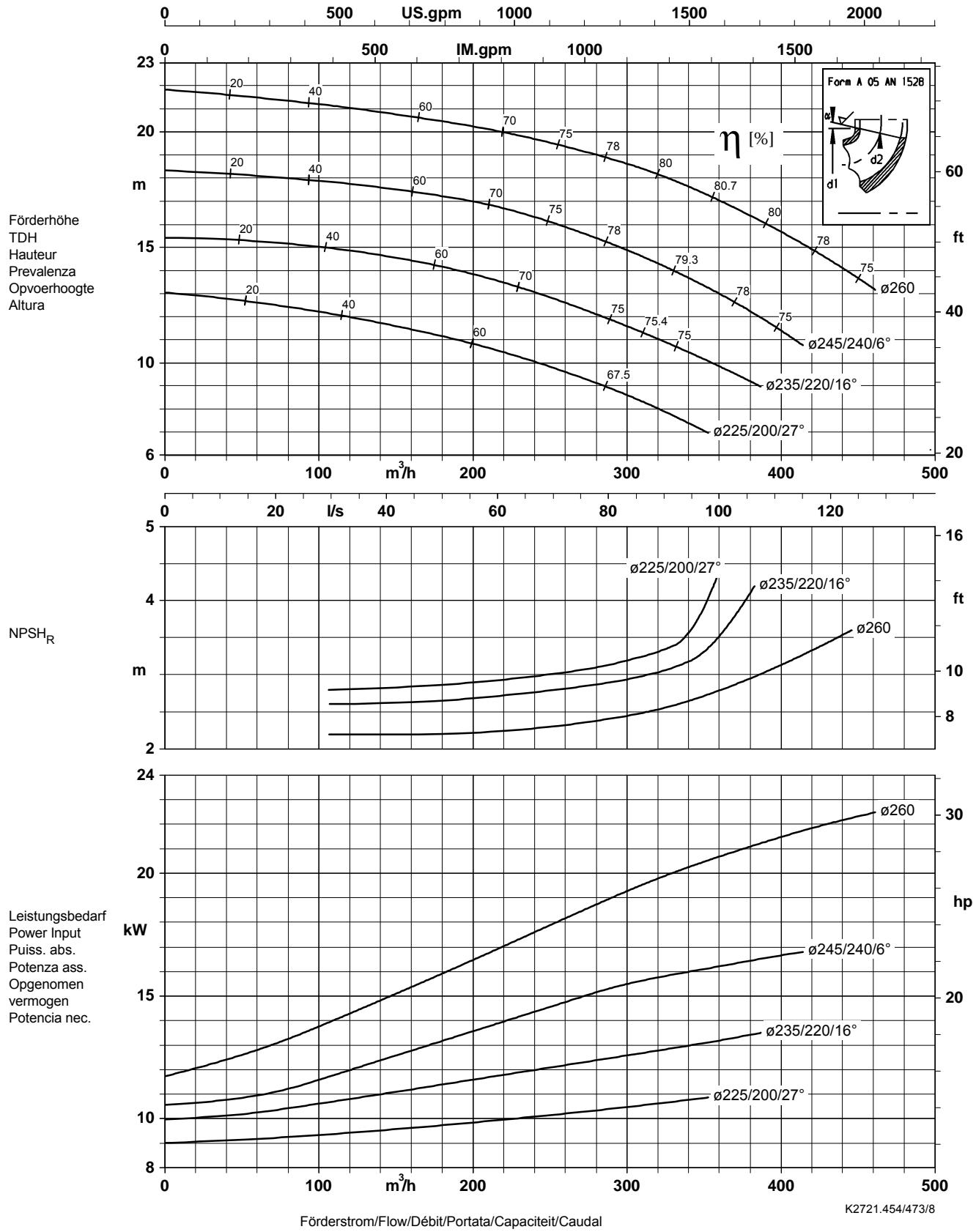
Laufradaustrittsbreite/Impeller outlet width/Largeur à la sortie de la roue 46.0 mm
