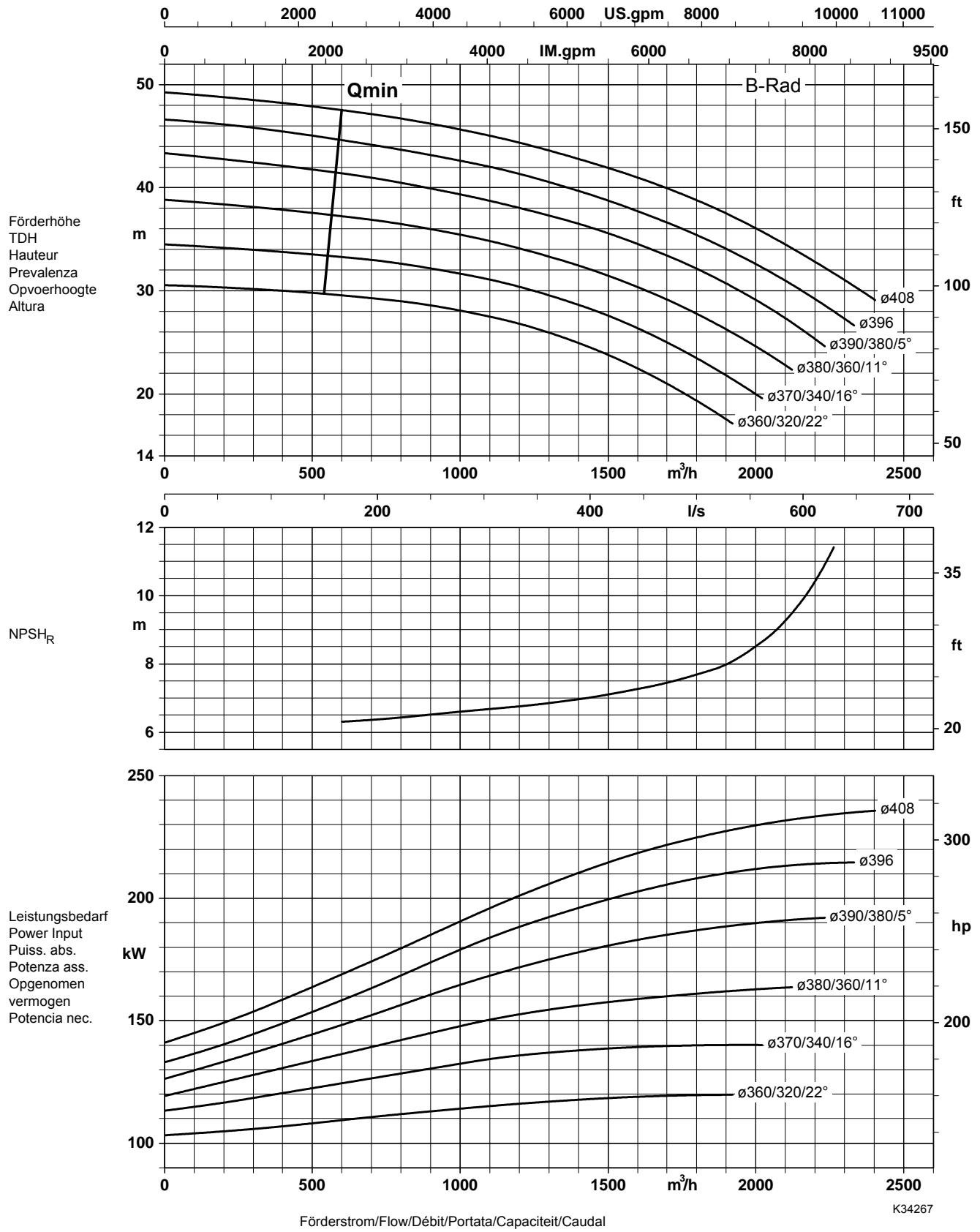
Laufradaustrittsbreite / Impeller outlet width / Largeur à la sortie de la roue 99,0 mm
