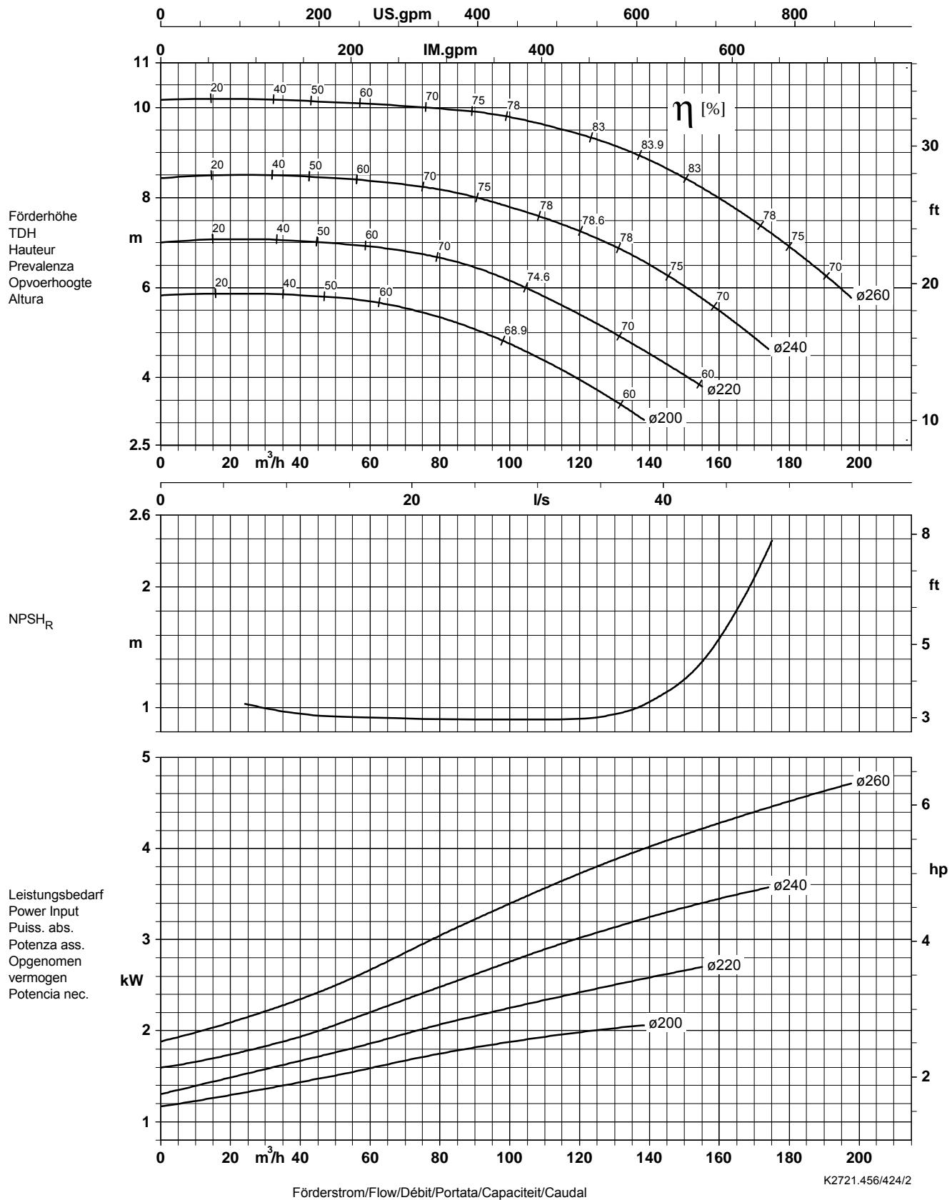
Laufradaustrittsbreite/Impeller outlet width/Largeur à la sortie de la roue 32.0 mm
