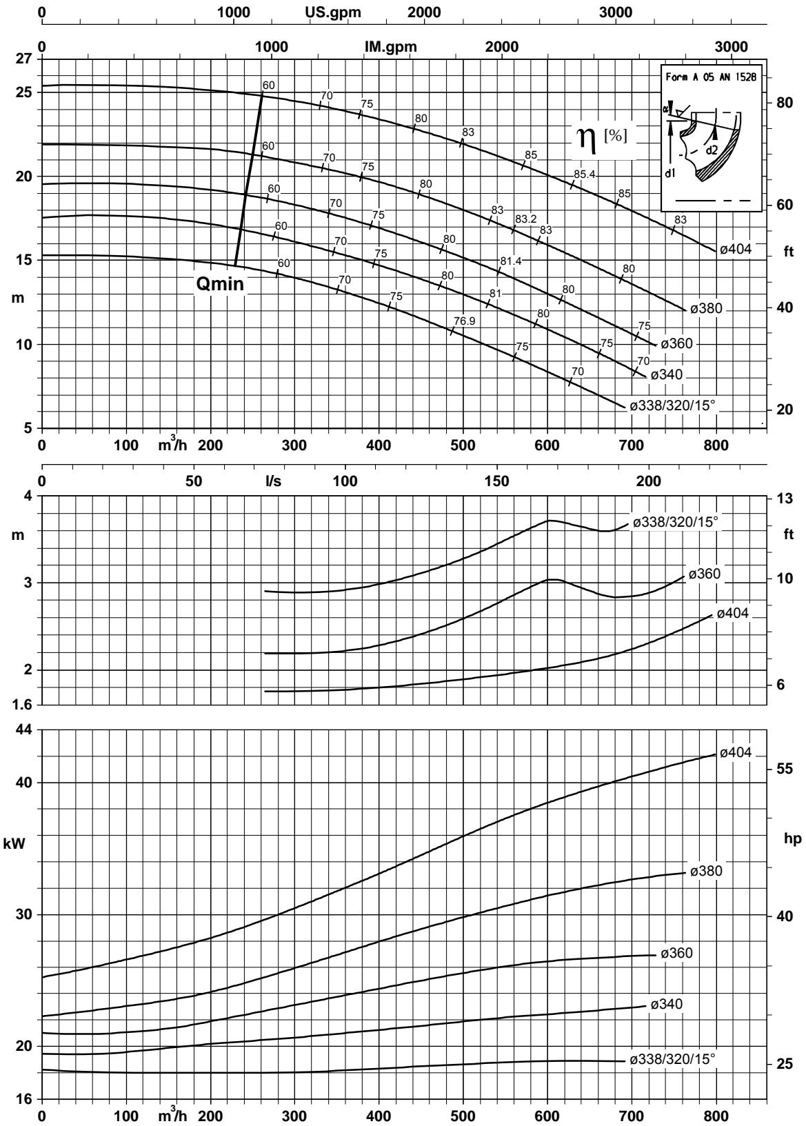
Laufradaustrittsbreite/Impeller outlet width/Largeur à la sortie de la roue 63,0 mm
