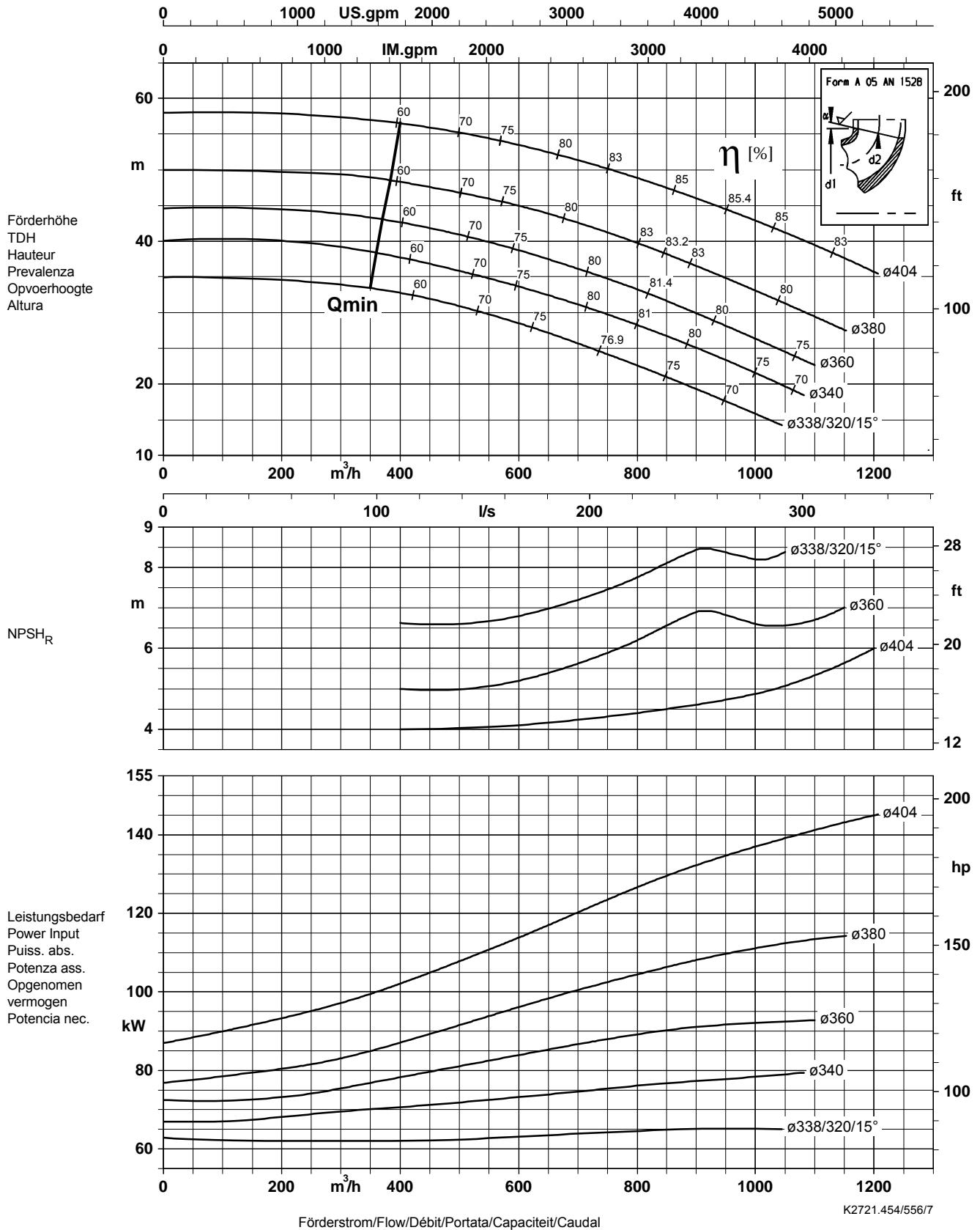
Laufradaustrittsbreite/Impeller outlet width/Largeur à la sortie de la roue 63,0 mm
