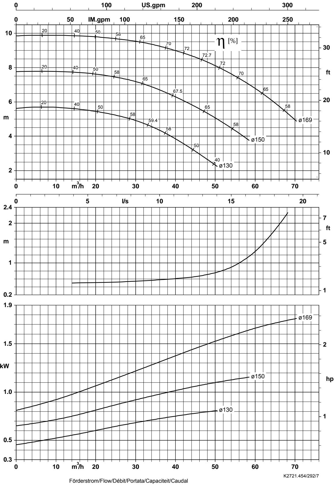
Laufraudraulitsbreite/Impeller outlet width/Largeur à la sortie de la roue 20,0 mm
