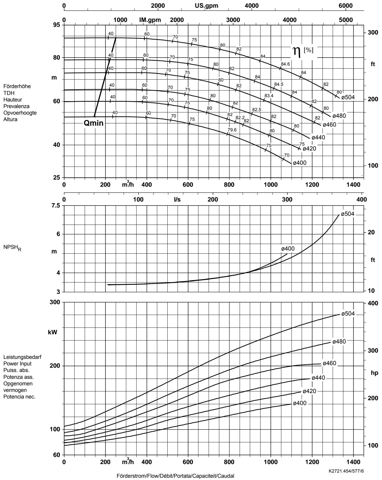
Laufraustrittsbreite/Impeller outlet width/Largeur à la sortie de la roue 43,0 mm
