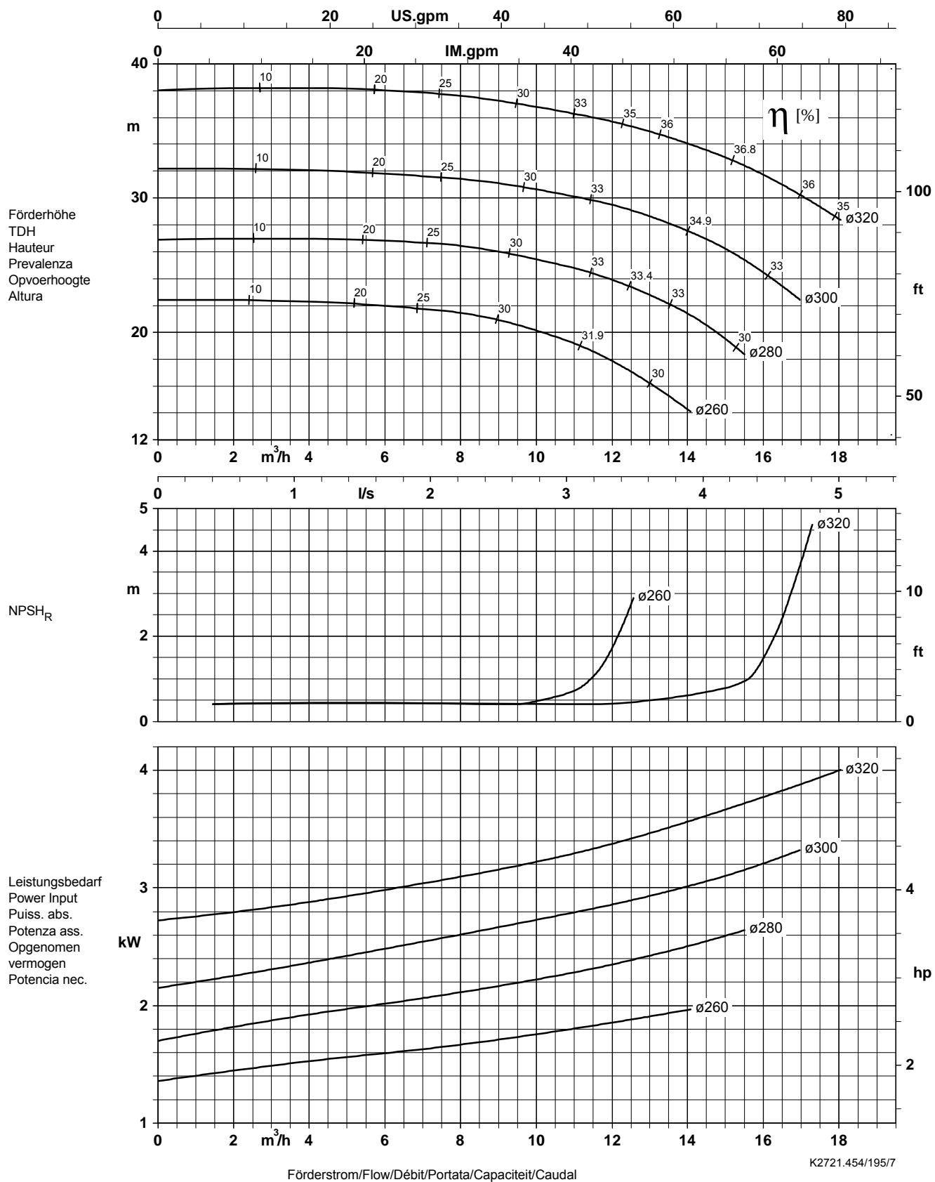
Laufradaustrittsbreite/Impeller outlet width/Largeur à la sortie de la roue 8,0 mm
