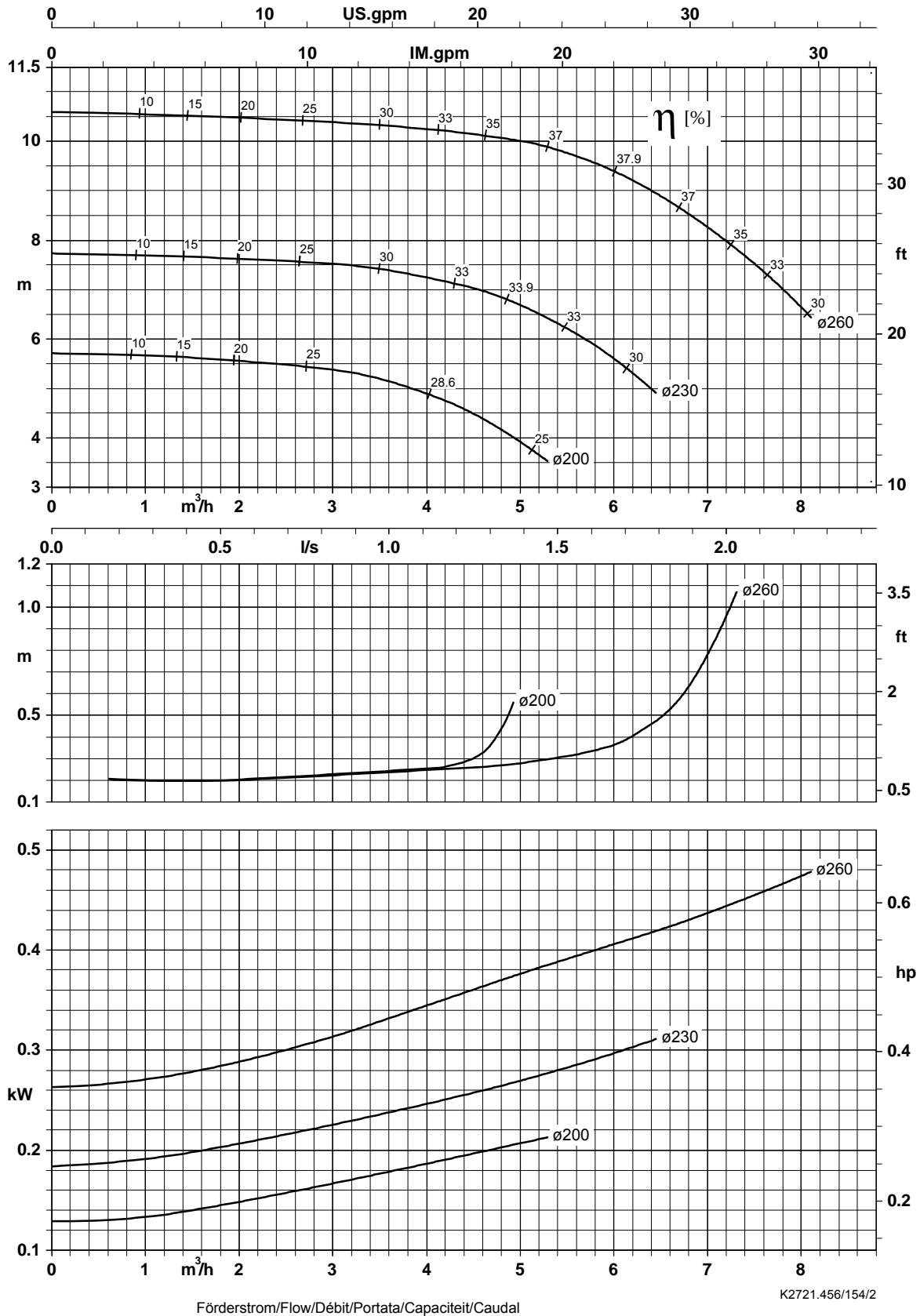
Laufradaustrittsbreite/Impeller outlet width/Largeur à la sortie de la roue 6,0 mm
