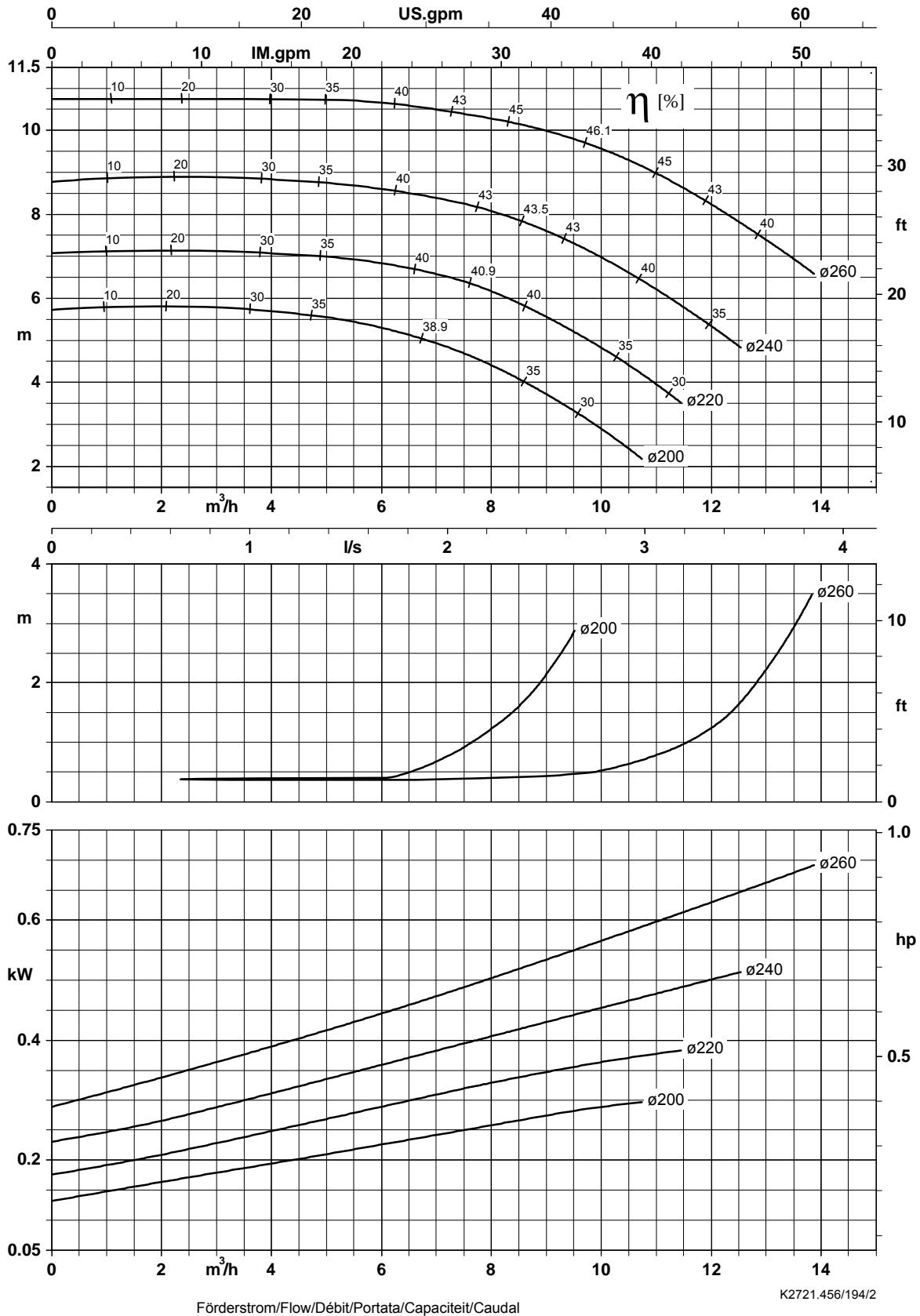
Laufrauadaustrittsbreite/Impeller outlet width/Largeur à la sortie de la roue 7,0 mm
