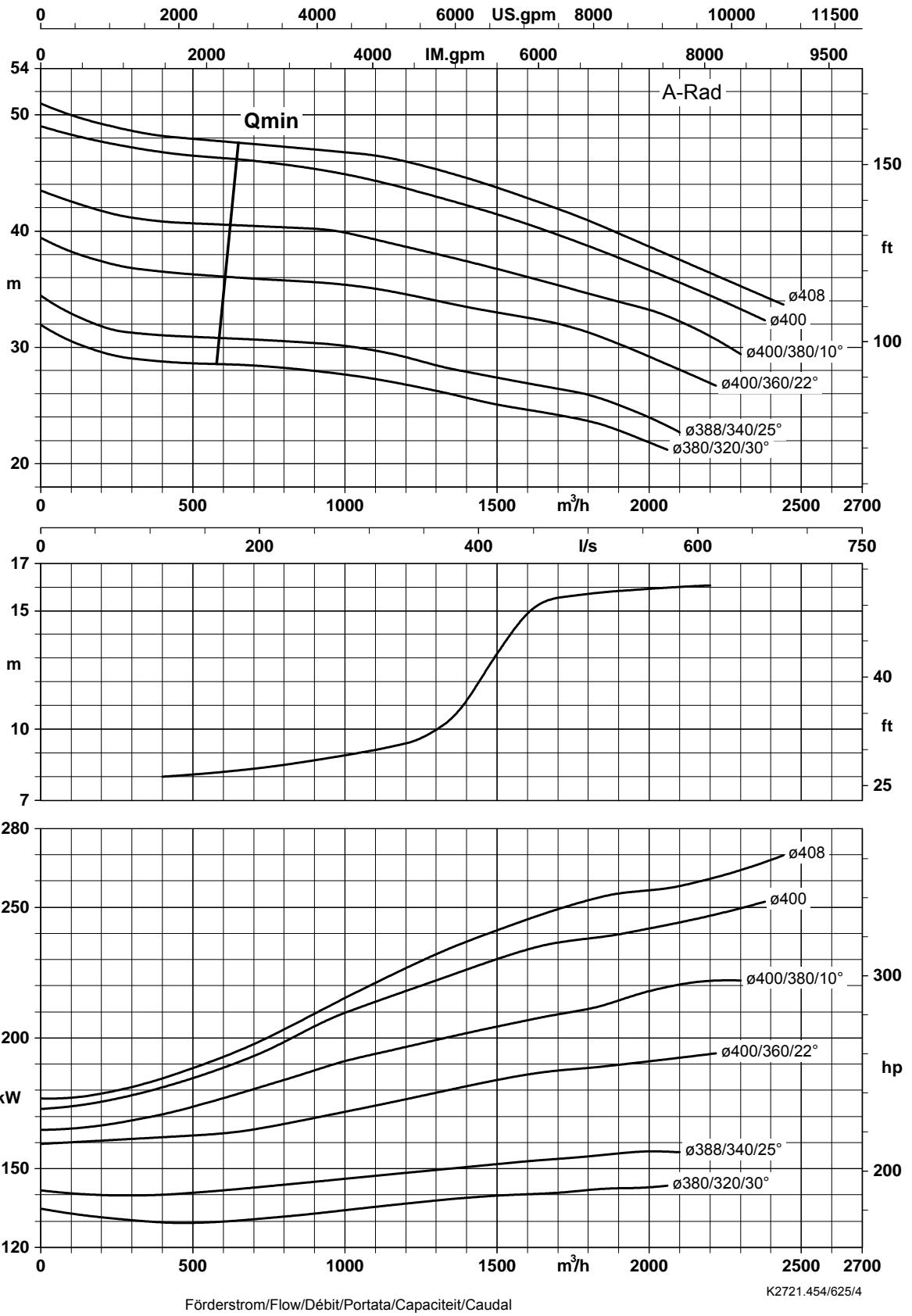
Laufradaustrittsbreite/Impeller outlet width/Largeur à la sortie de la roue 115.0 mm
