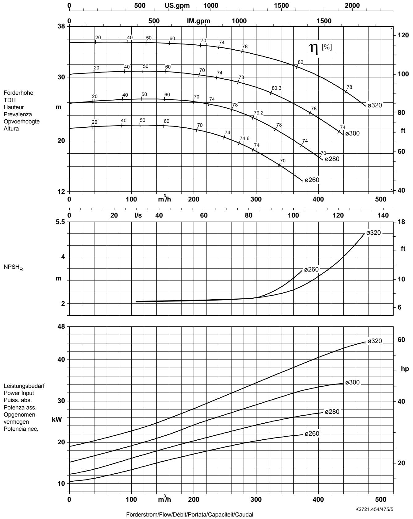
Laufradaustrittsbreite/Impeller outlet width/Largeur à la sortie de la roue 38,0 mm
