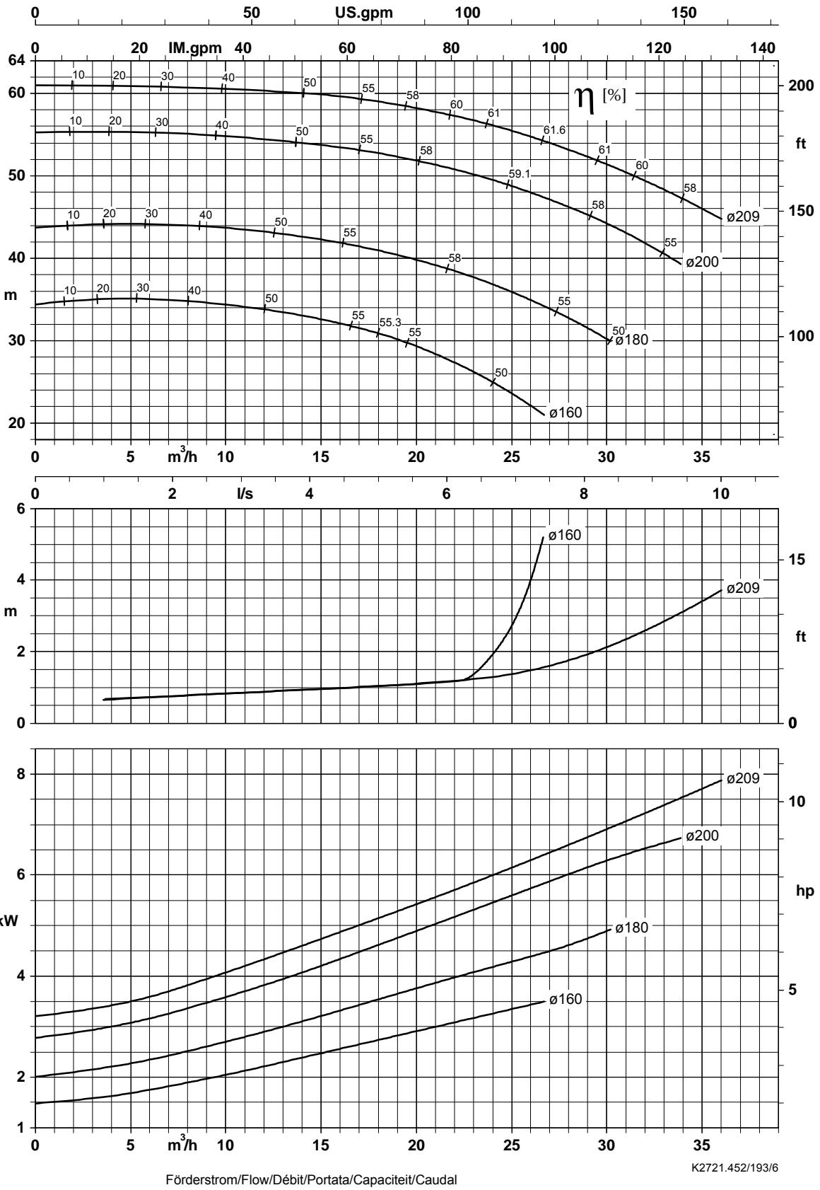
Laufradaustrittsbreite/Impeller outlet width/Largeur à la sortie de la roue 7,0 mm
