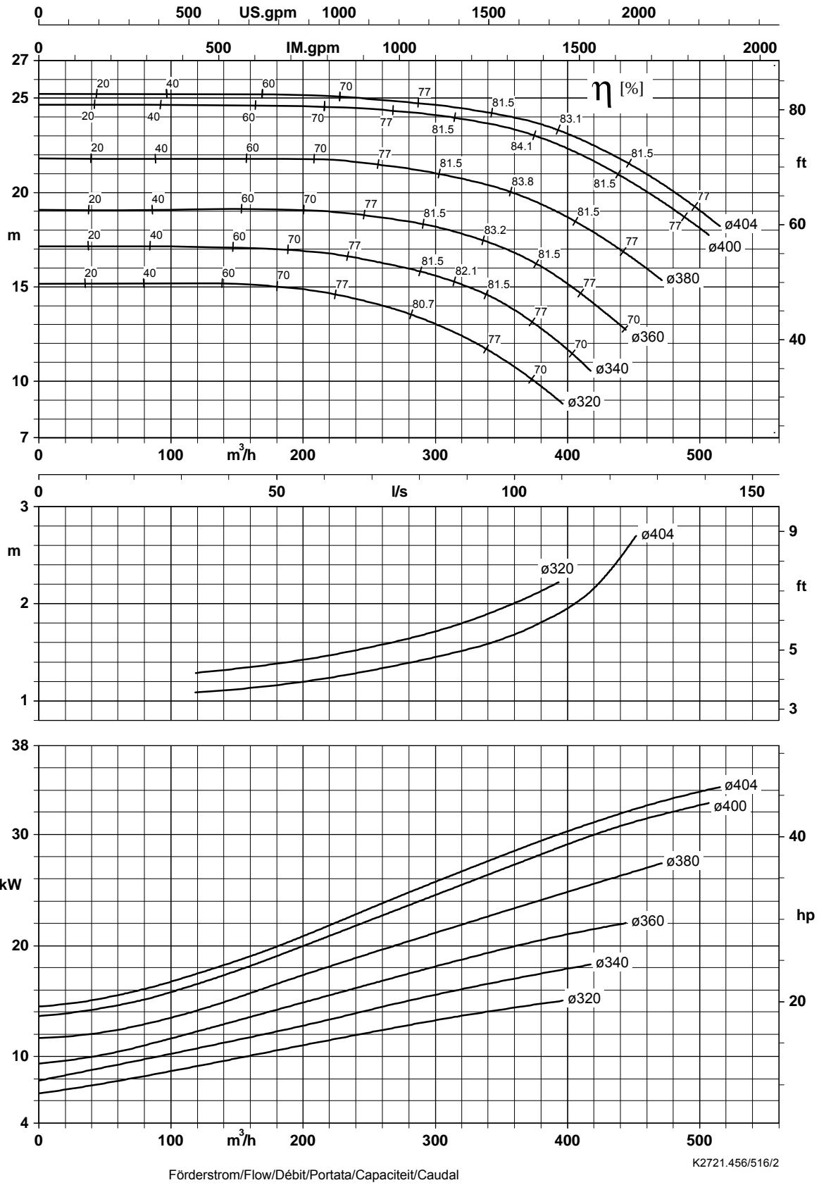
Laufradaustrittsbreite/Impeller outlet width/Largeur à la sortie de la roue 40,0 mm
