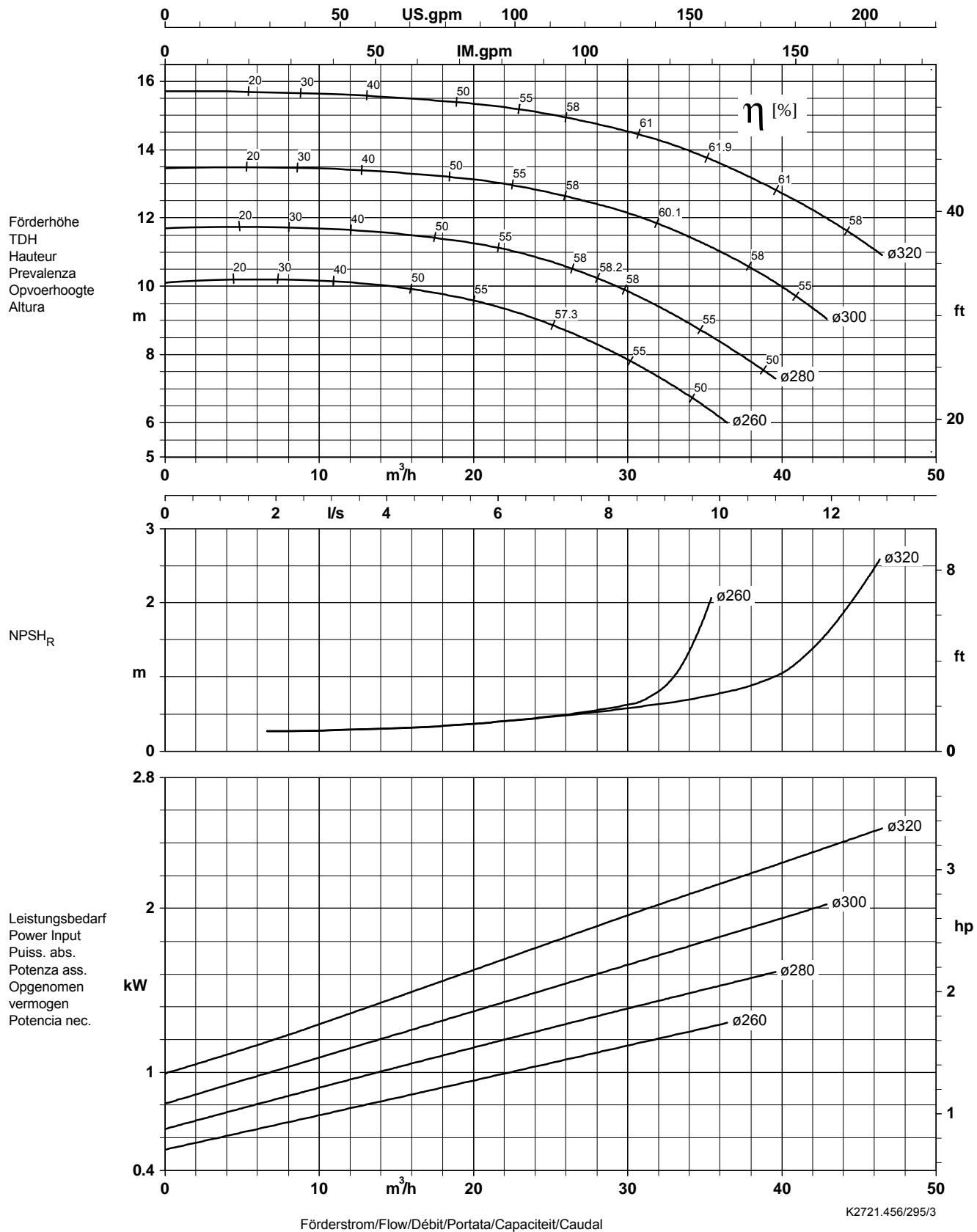
Laufradaustrittsbreite/Impeller outlet width/Largeur à la sortie de la roue 10,0 mm
