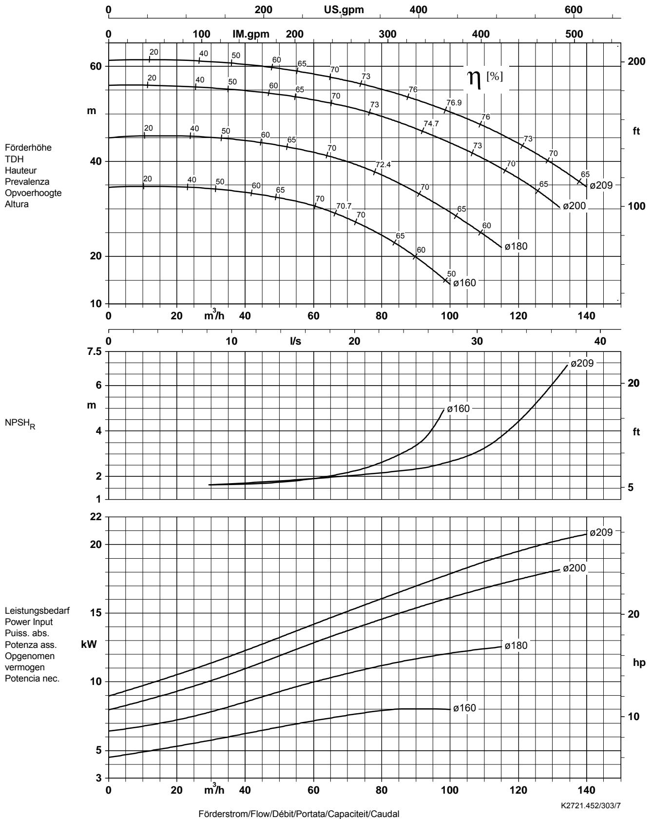
Laufradaustrittsbreite/Impeller outlet width/Largeur à la sortie de la roue 16,0 mm
