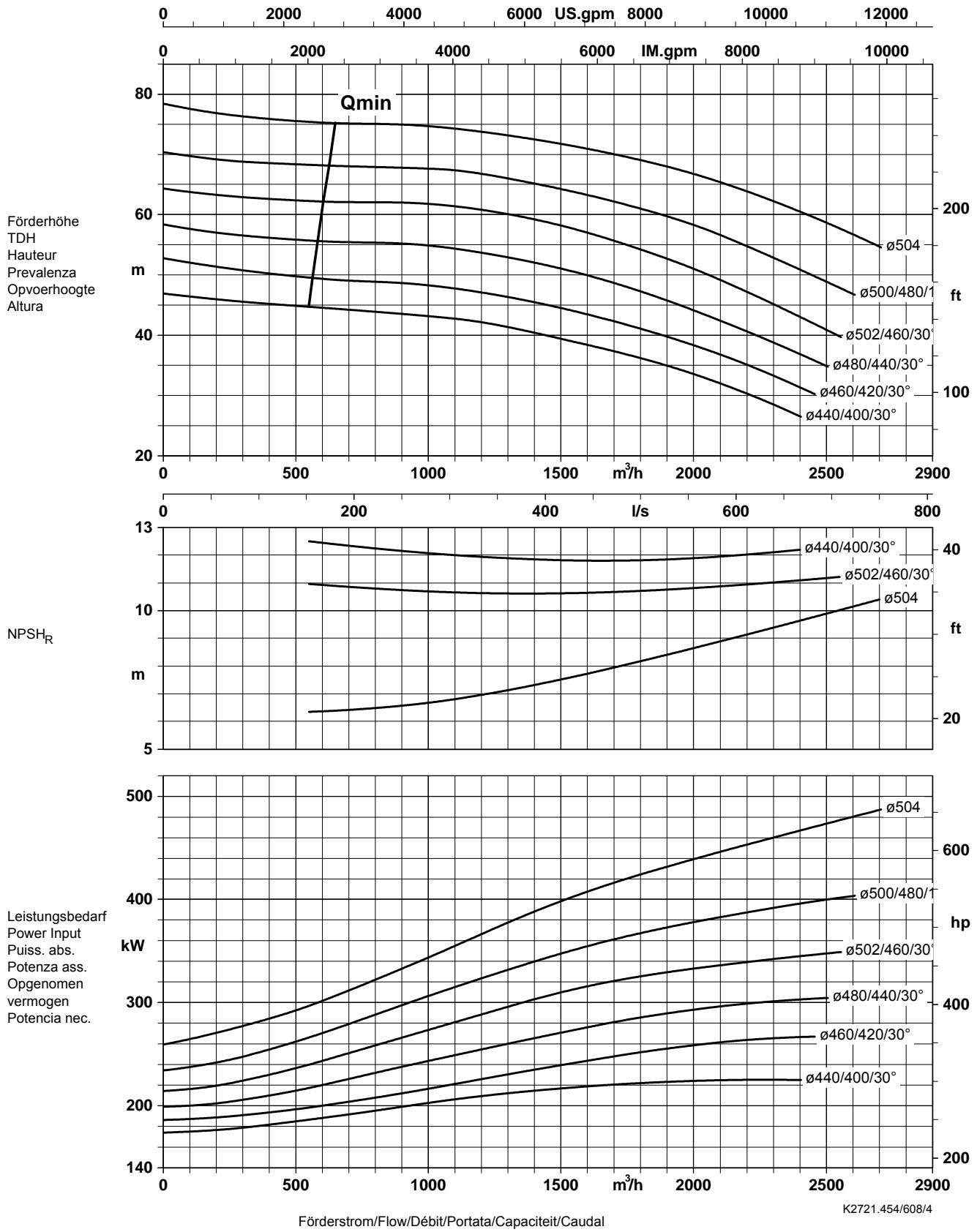
Laufradaustrittsbreite/Impeller outlet width/Largeur à la sortie de la roue 72,0 mm
