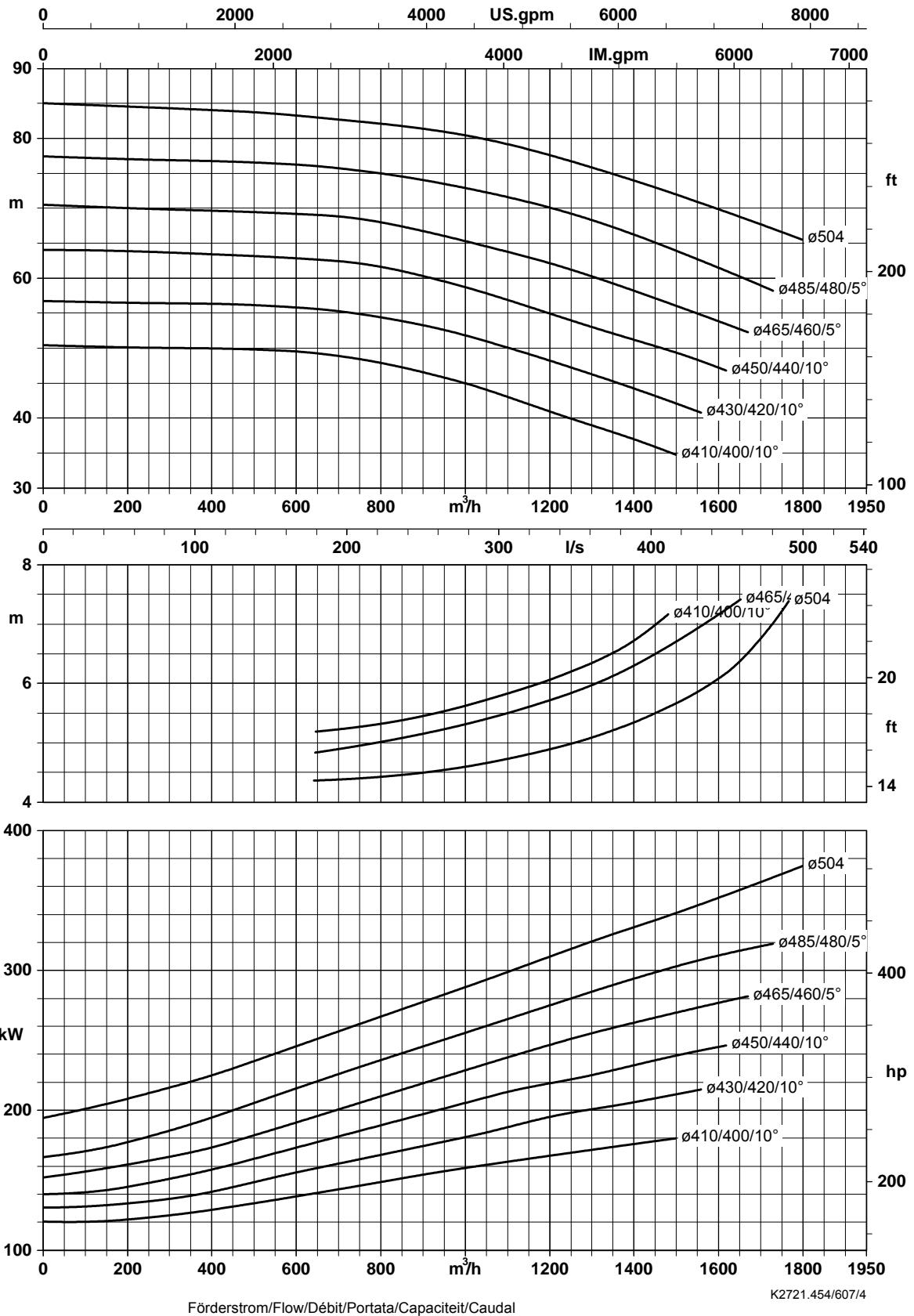
Laufraustrittsbreite/Impeller outlet width/Largeur à la sortie de la roue 58,0 mm
