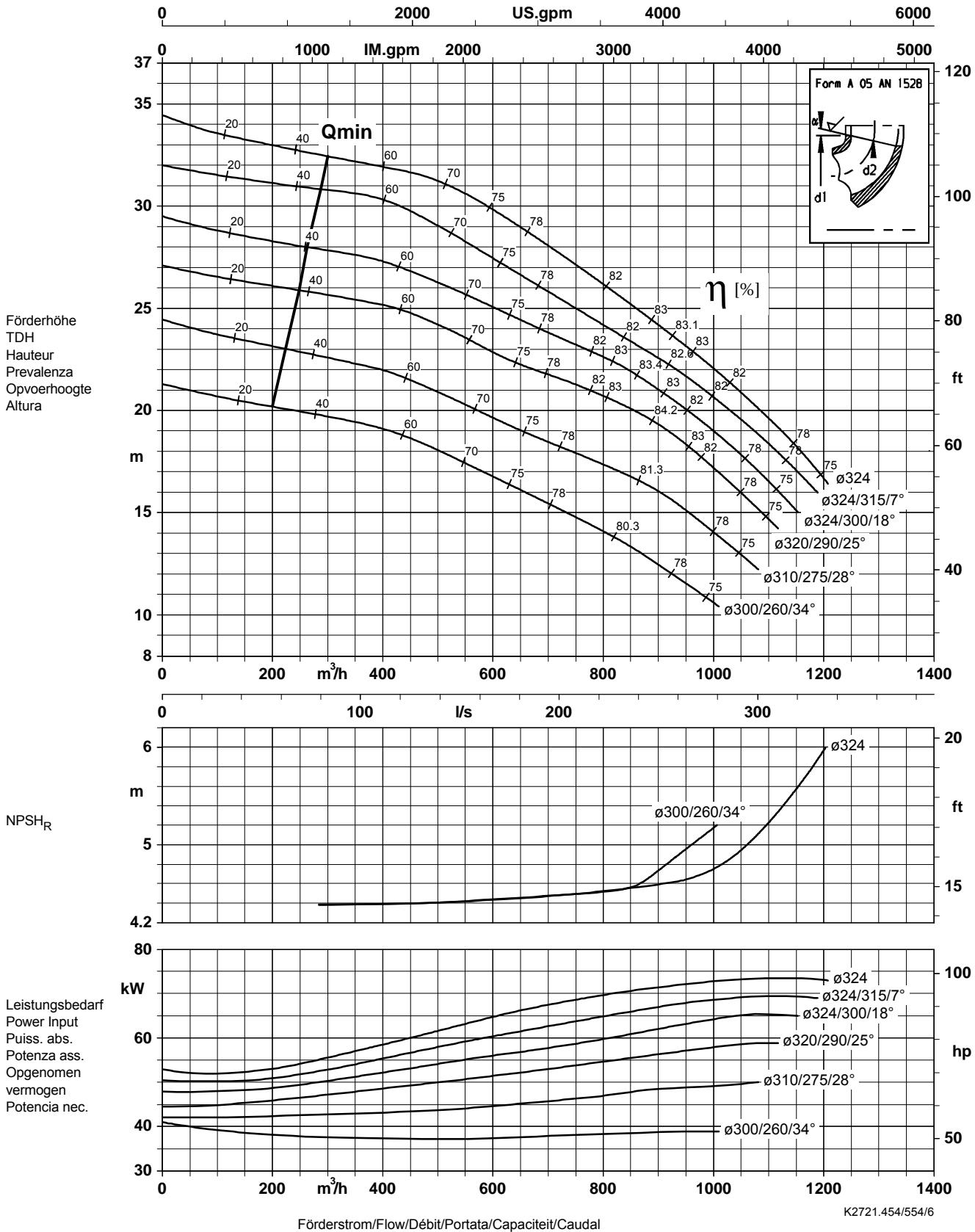
Laufradaustrittsbreite/Impeller outlet width/Largeur à la sortie de la roue 73,0 mm
