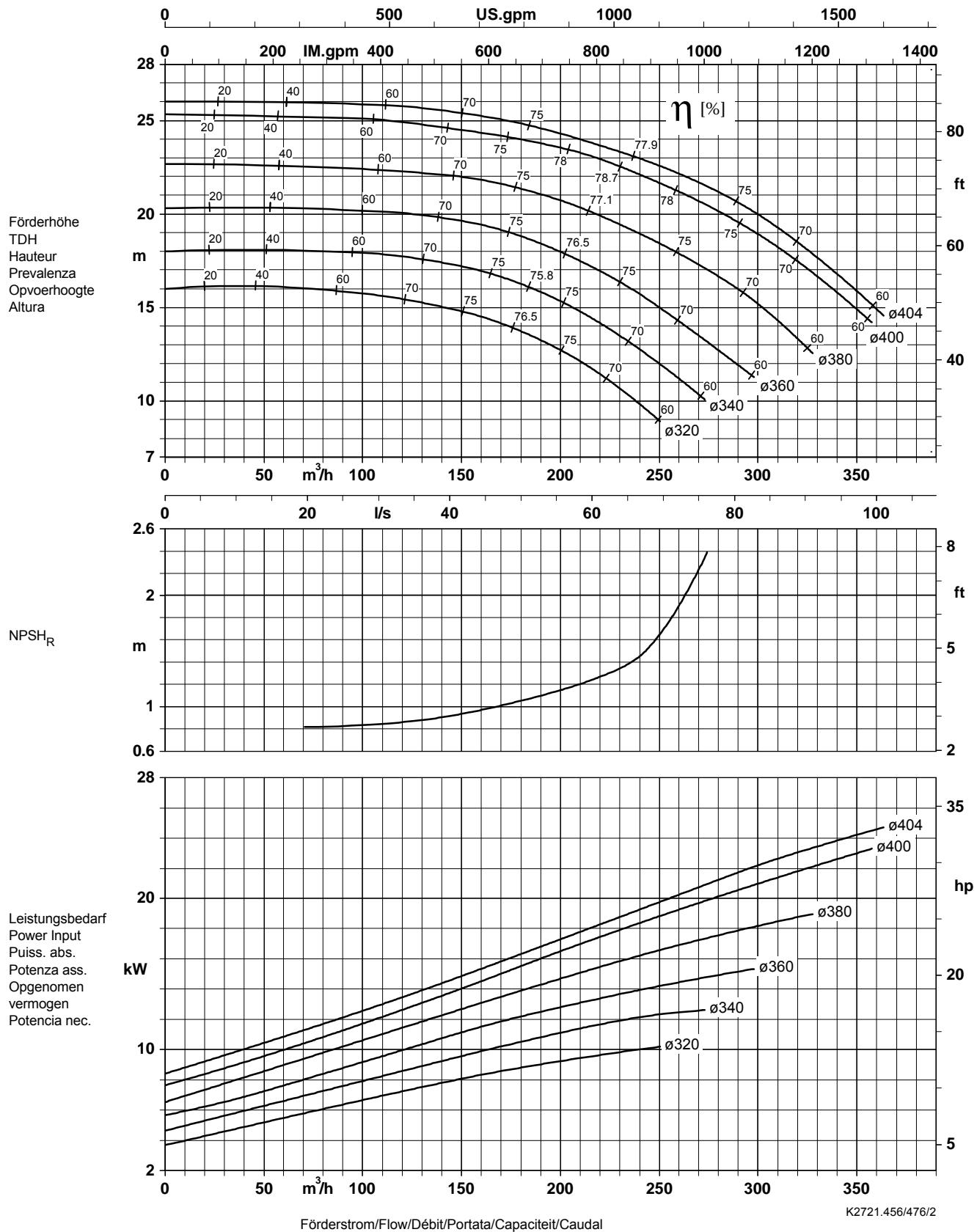
Laufradaustrittsbreite/Impeller outlet width/Largeur à la sortie de la roue 29,0 mm
