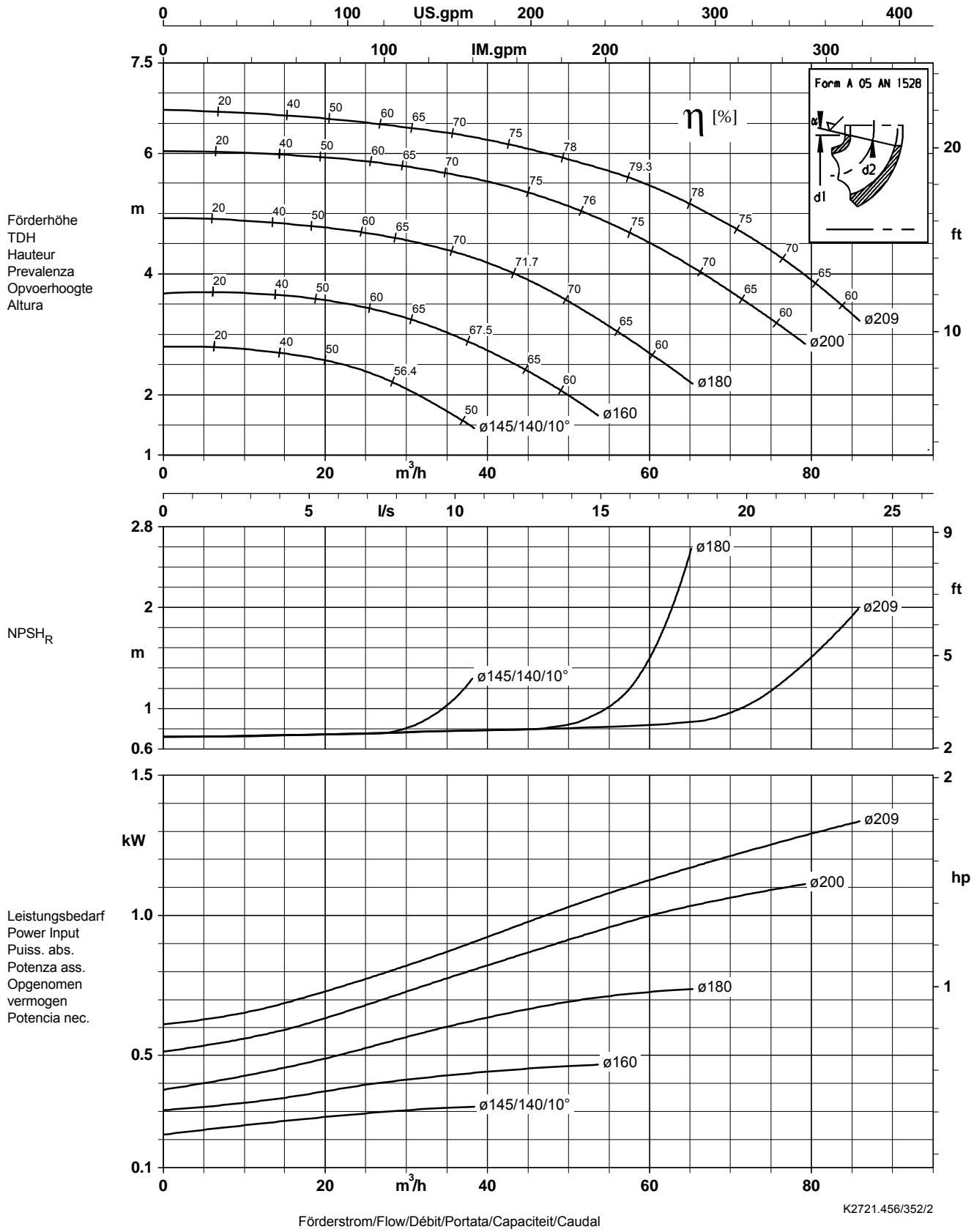
Laufradaustrittsbreite/Impeller outlet width/Largeur à la sortie de la roue 22.0 mm
