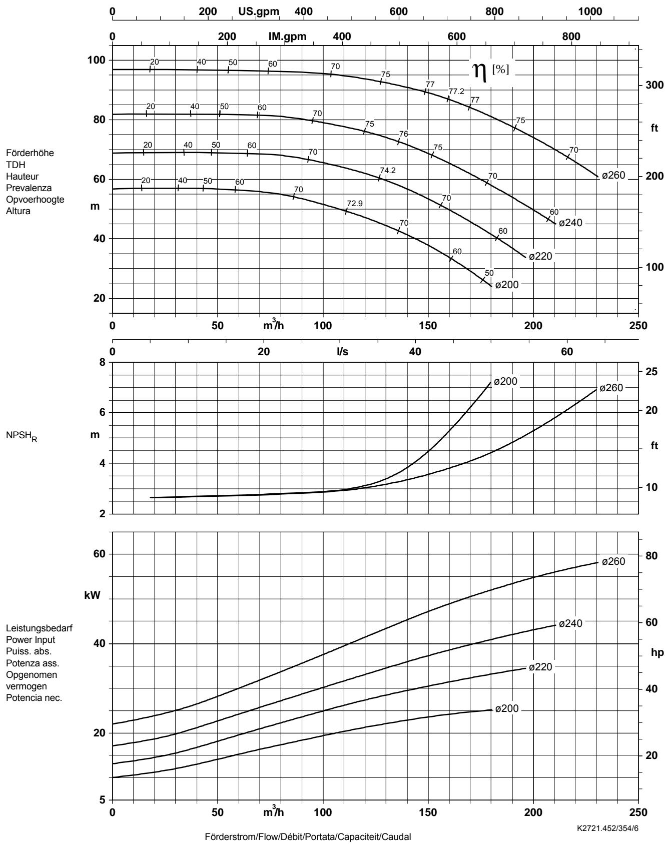
Laufradaustrittsbreite/Impeller outlet width/Largeur à la sortie de la roue 17,0 mm
