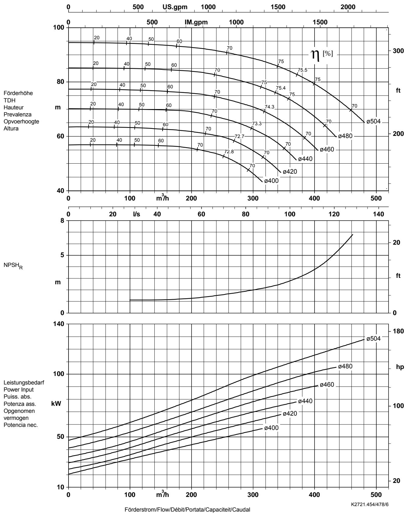
Laufradaustrittsbreite/Impeller outlet width/Largeur à la sortie de la roue 23,0 mm
