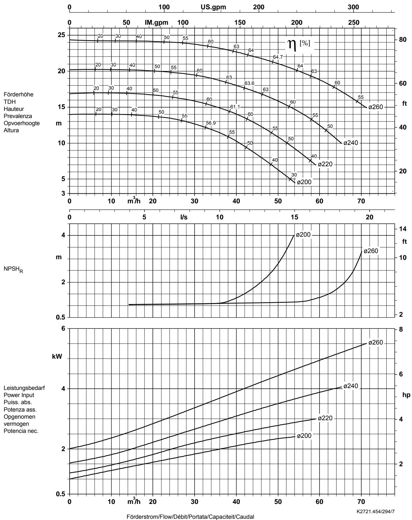
Laufradaustrittsbreite/Impeller outlet width/Largeur à la sortie de la roue 13,0 mm
