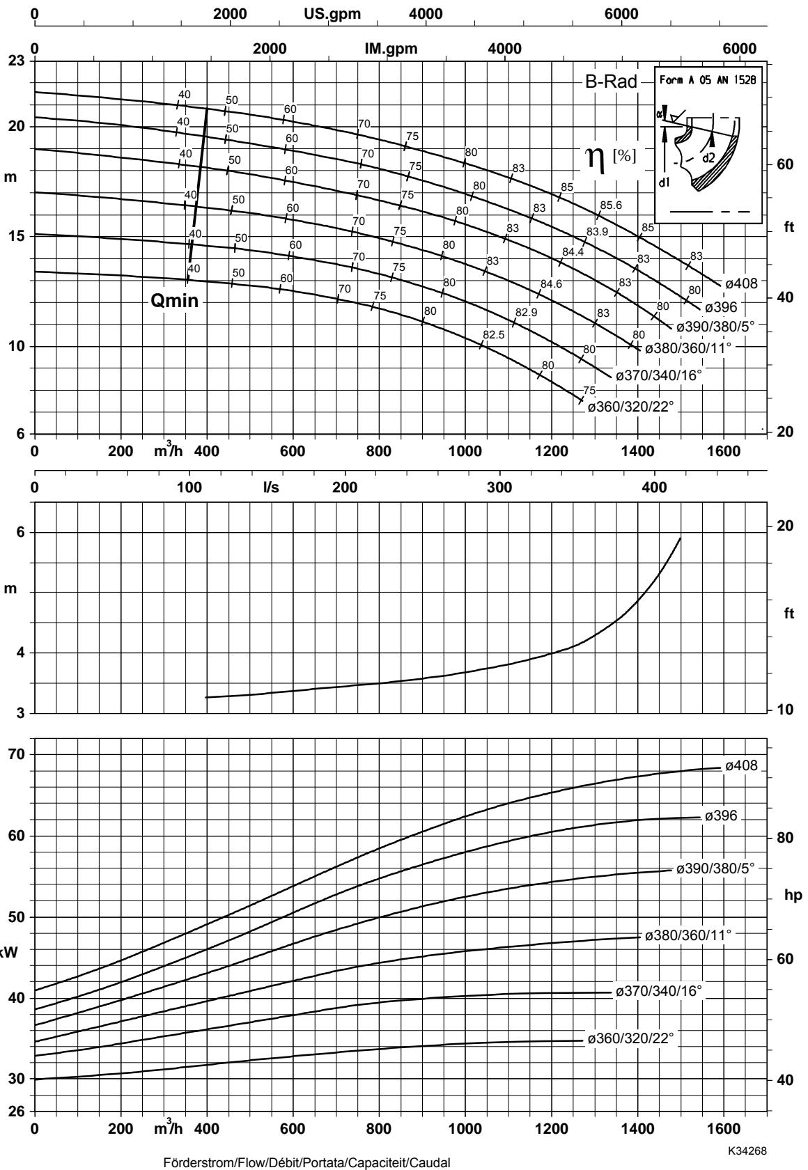
Laufradaustrittsbreite/Impeller outlet width/Largeur à la sortie de la roue 99,0 mm
