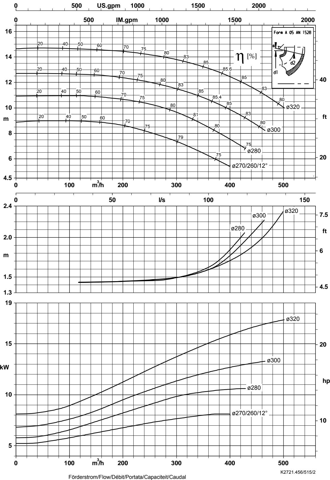
Laufradaustrittsbreite/Impeller outlet width/Largeur à la sortie de la roue 50,0 mm
