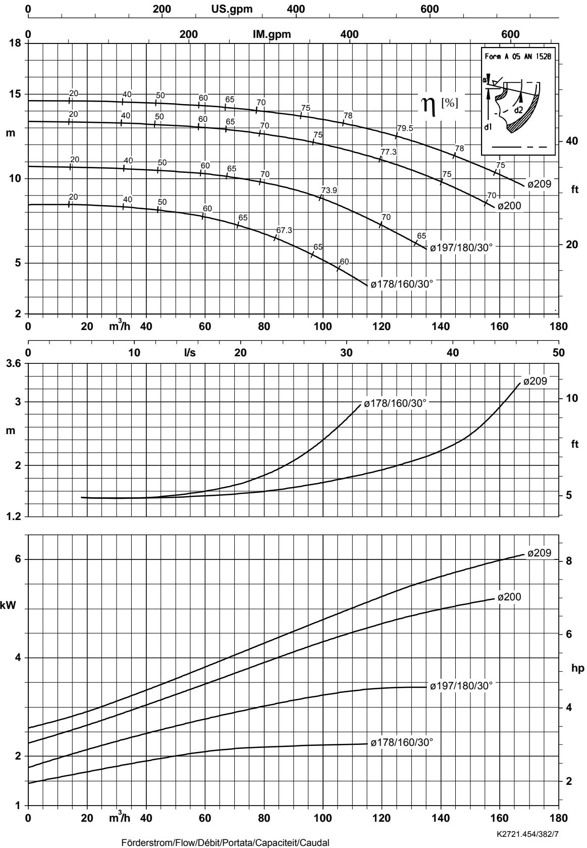
Laufradaustrittsbreite/Impeller outlet width/Largeur à la sortie de la roue 29,0 mm
