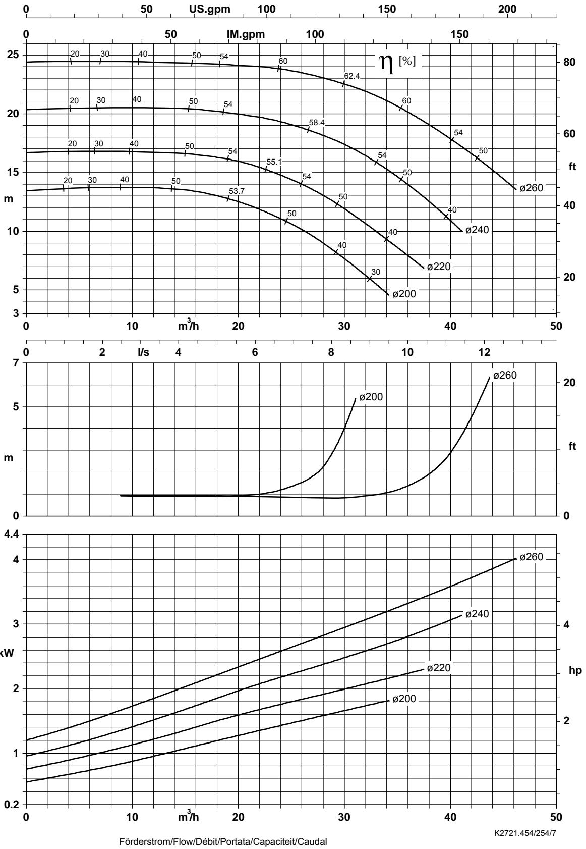
Laufradaustrittsbreite/Impeller outlet width/Largeur à la sortie de la roue 10,0 mm
