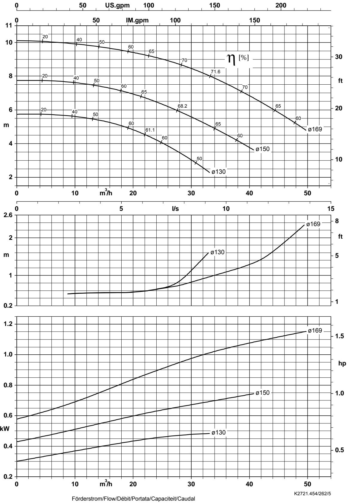
Laufradaustrittsbreite/Impeller outlet width/Largeur à la sortie de la roue 15,0 mm
