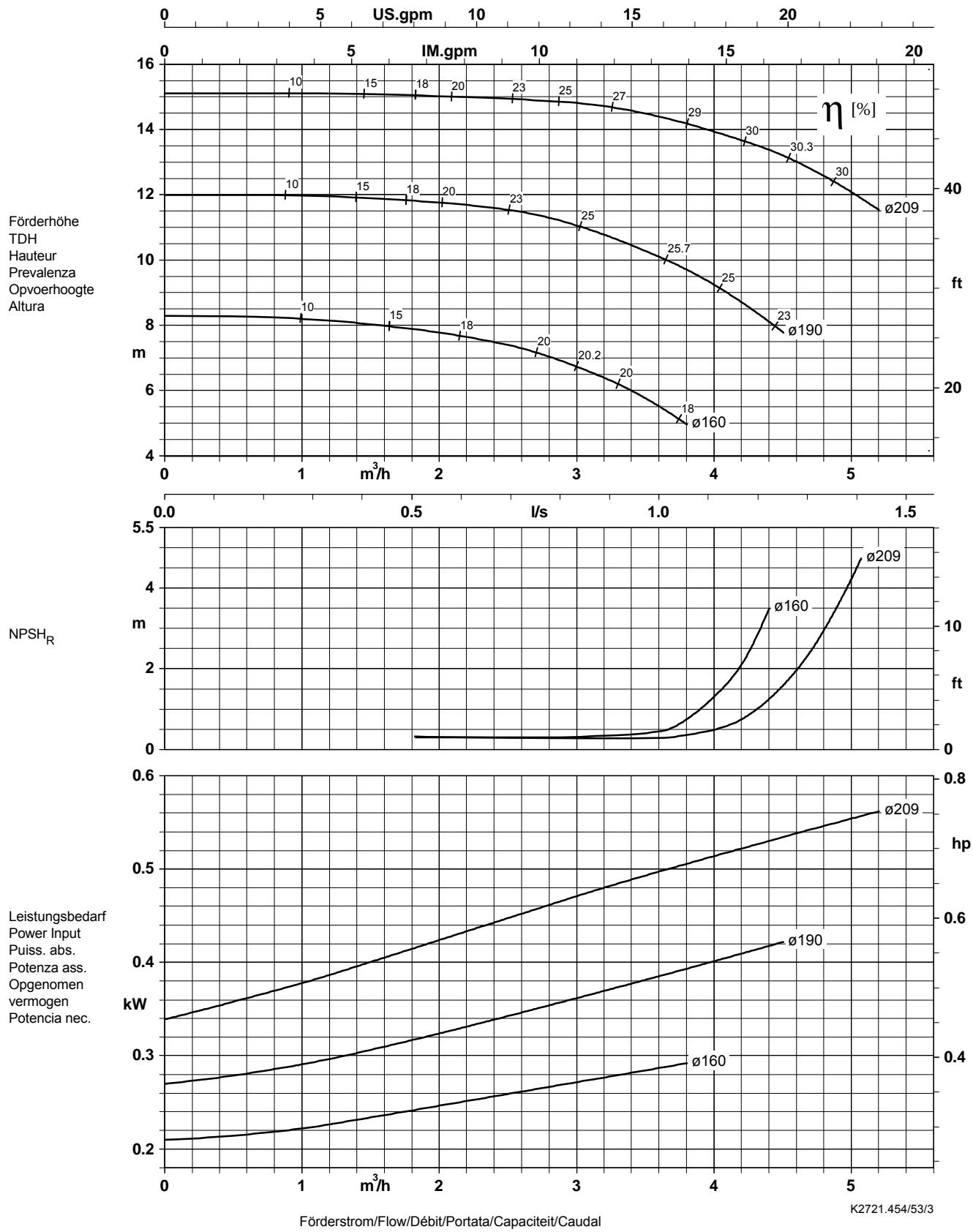
Laufradaustrittsbreite/Impeller outlet width/Largeur à la sortie de la roue 6,0 mm
