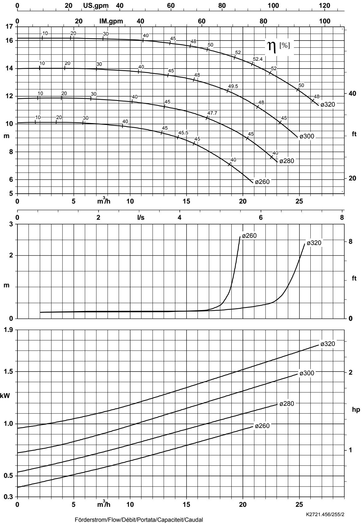
Laufradaustrittsbreite/Impeller outlet width/Largeur à la sortie de la roue 8,0 mm
