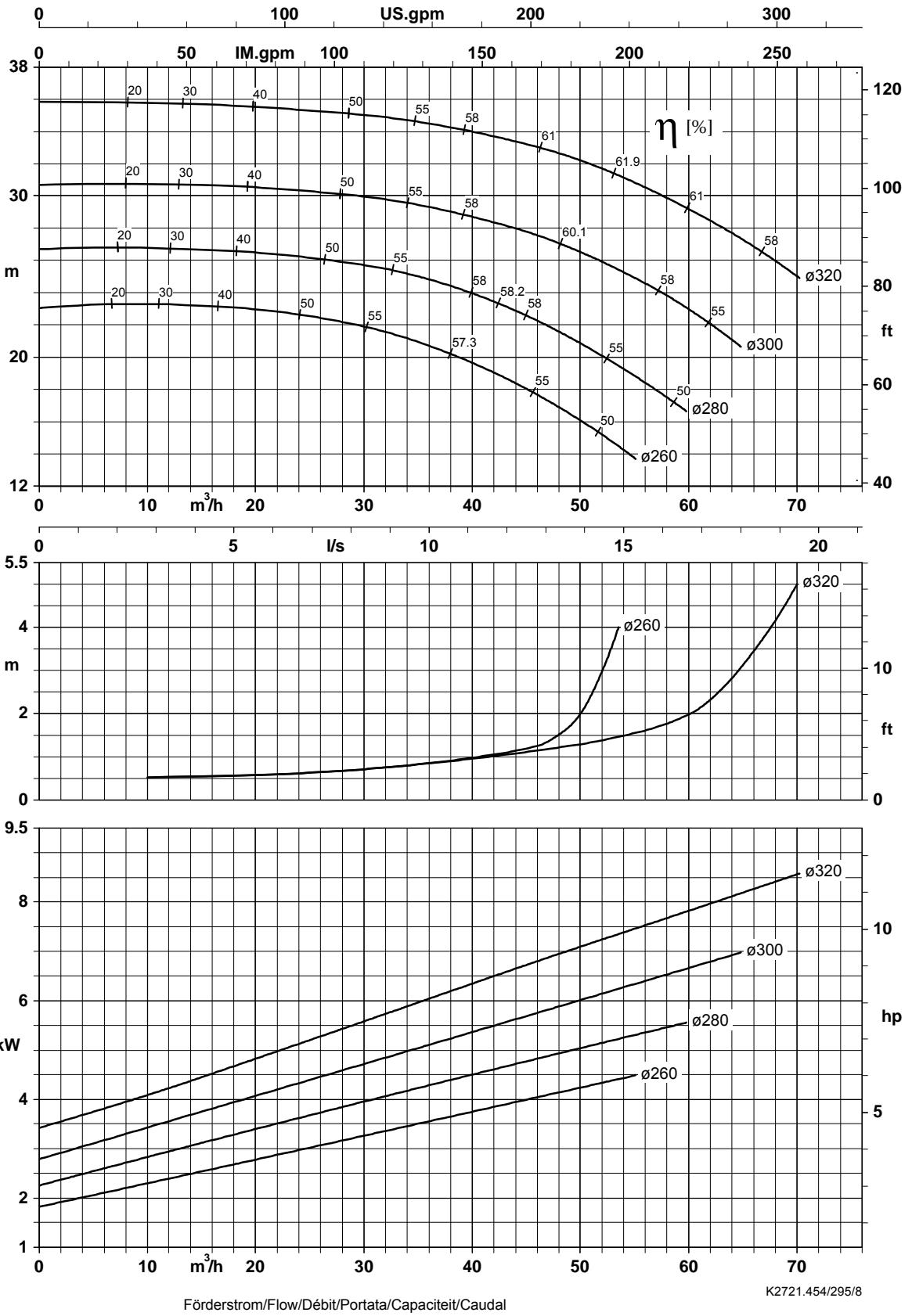
Laufrauaduistrtsbreite/Impeller outlet width/Largeur à la sortie de la roue 10,0 mm
