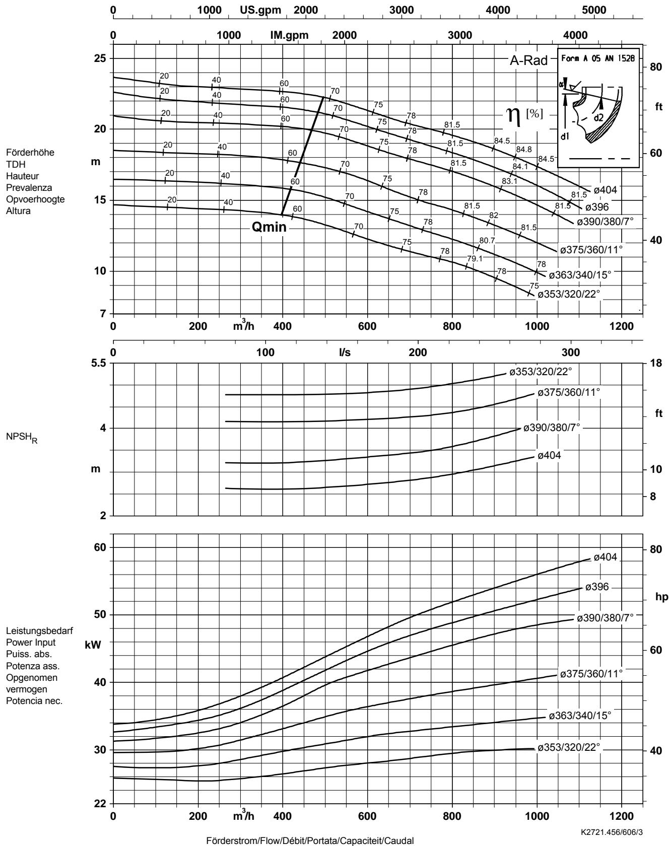
Laufradaustrittsbreite/Impeller outlet width/Largeur à la sortie de la roue 68.0 mm
