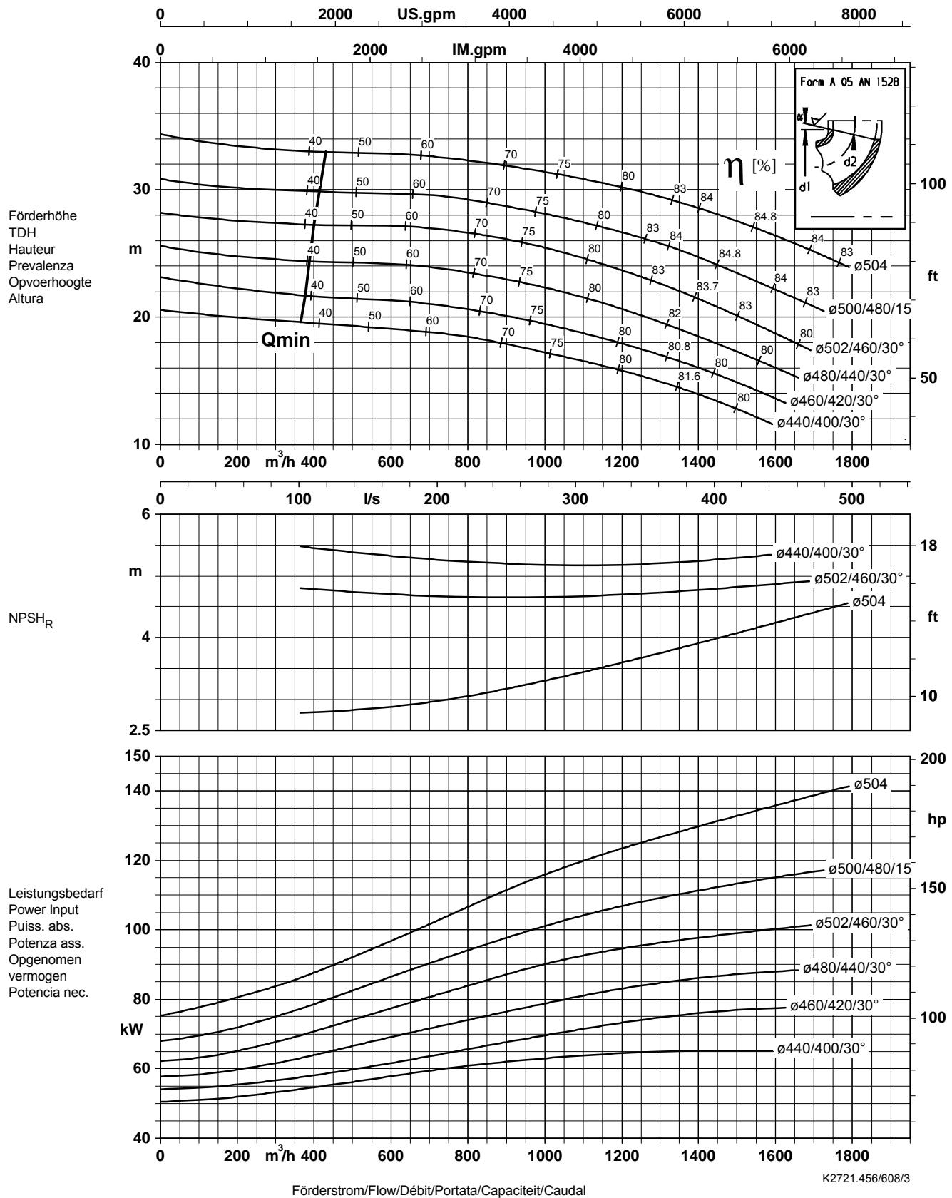
Laufraudaustrittsbreite/Impeller outlet width/Largeur à la sortie de la roue 72,0 mm
