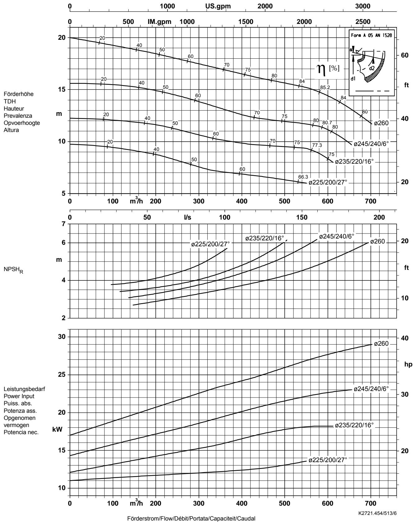
Laufradaustrittsbreite/Impeller outlet width/Largeur à la sortie de la roue 62,0 mm
