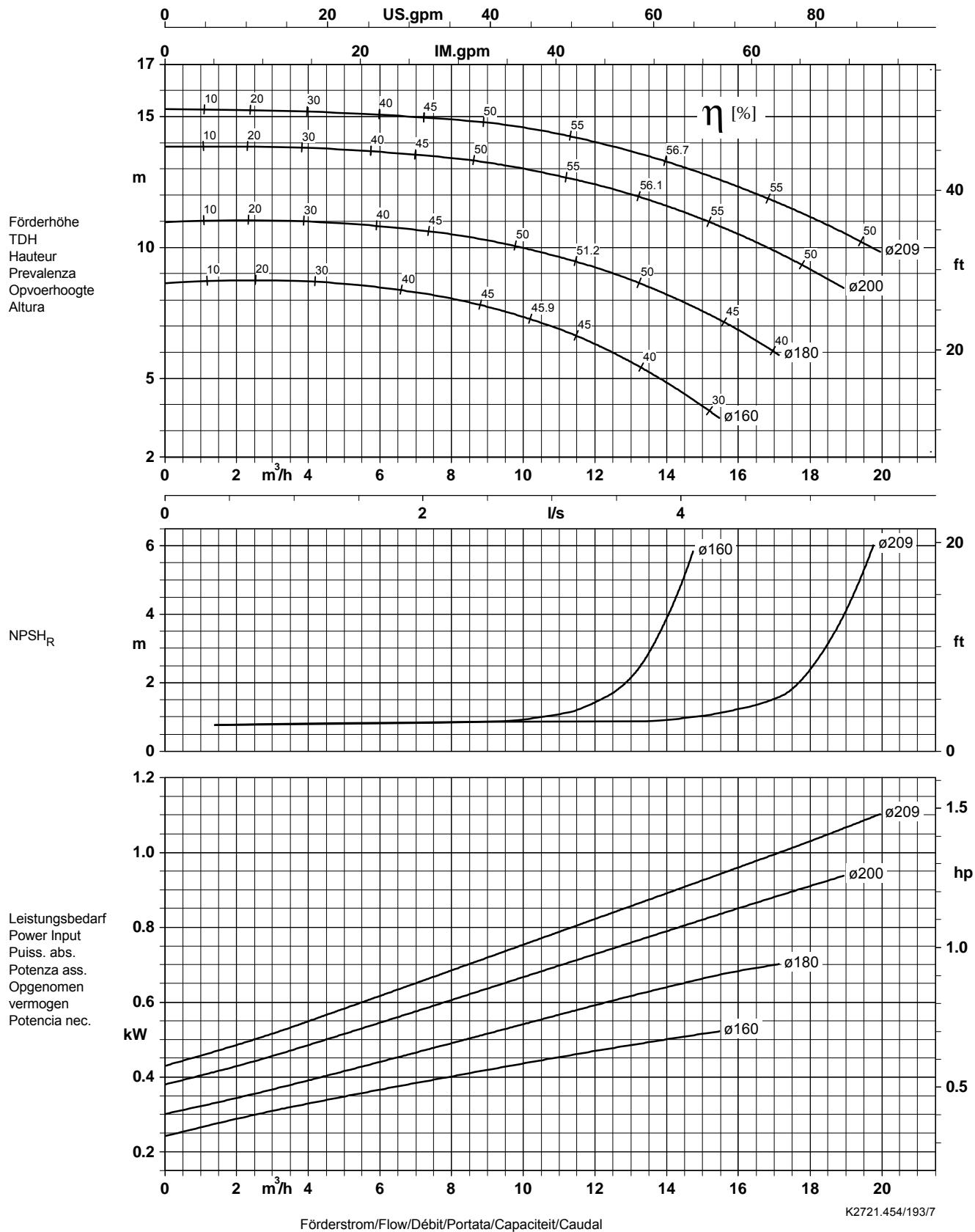
Laufradaustrittsbreite/Impeller outlet width/Largeur à la sortie de la roue 7,0 mm
